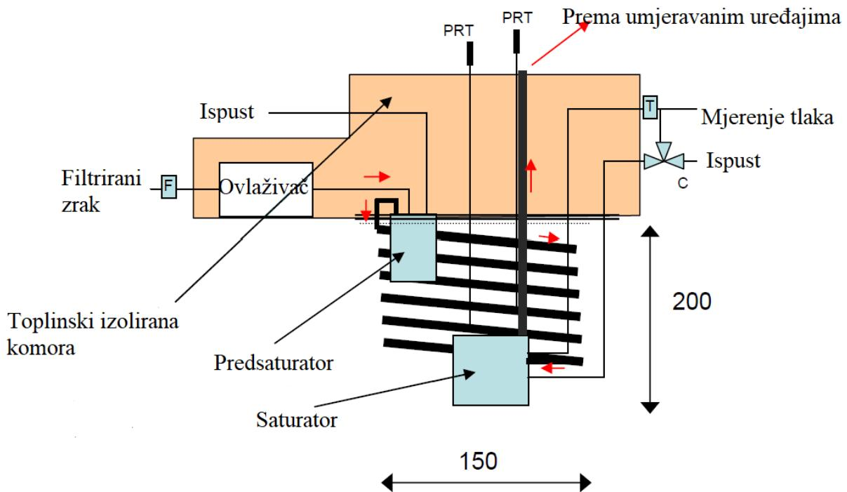
Slika 8. Shema visokotemperaturnog saturatora HRS [7]
