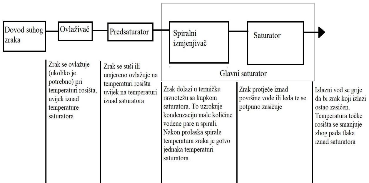
Slika 4. Shema termodinamičkog procesa saturatora [7]
