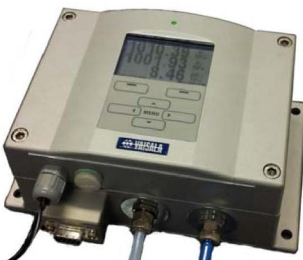
**Slika 21. Precizni barometar [4]**
