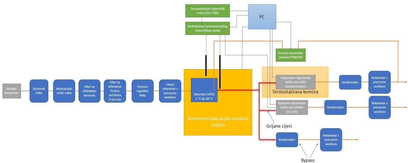
Slika 10. Shema mjerne linije za temperaturno područje od  $10^{\circ}\text{C}$  do  $60^{\circ}\text{C}$
