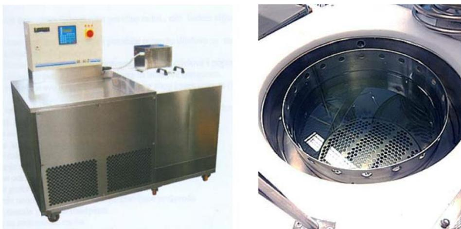
**Slika 18. Kupka za regulaciju temperature saturatora [4]**
