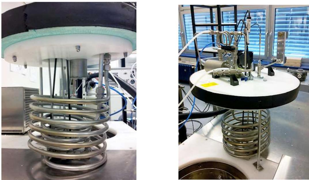
Slika 11. Niskotemperaturni saturator [3]
