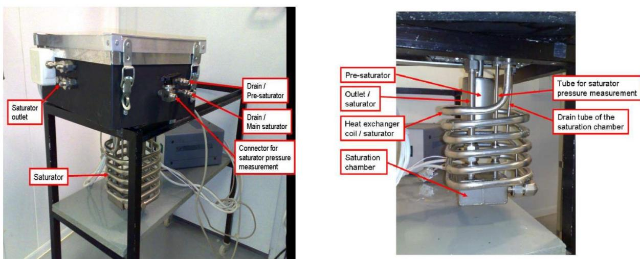
Slika 12. Visokotemperaturni saturator [3]
