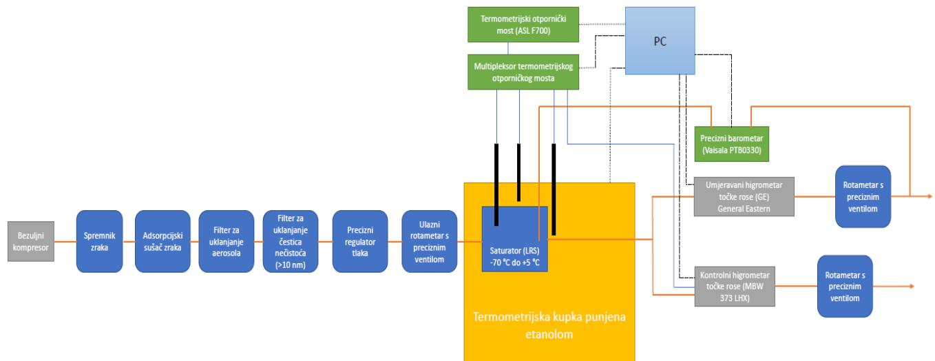
Slika 9. Shema mjerne linije za temperaturno područje od  $-25^{\circ}\text{C}$  do  $1^{\circ}\text{C}$
