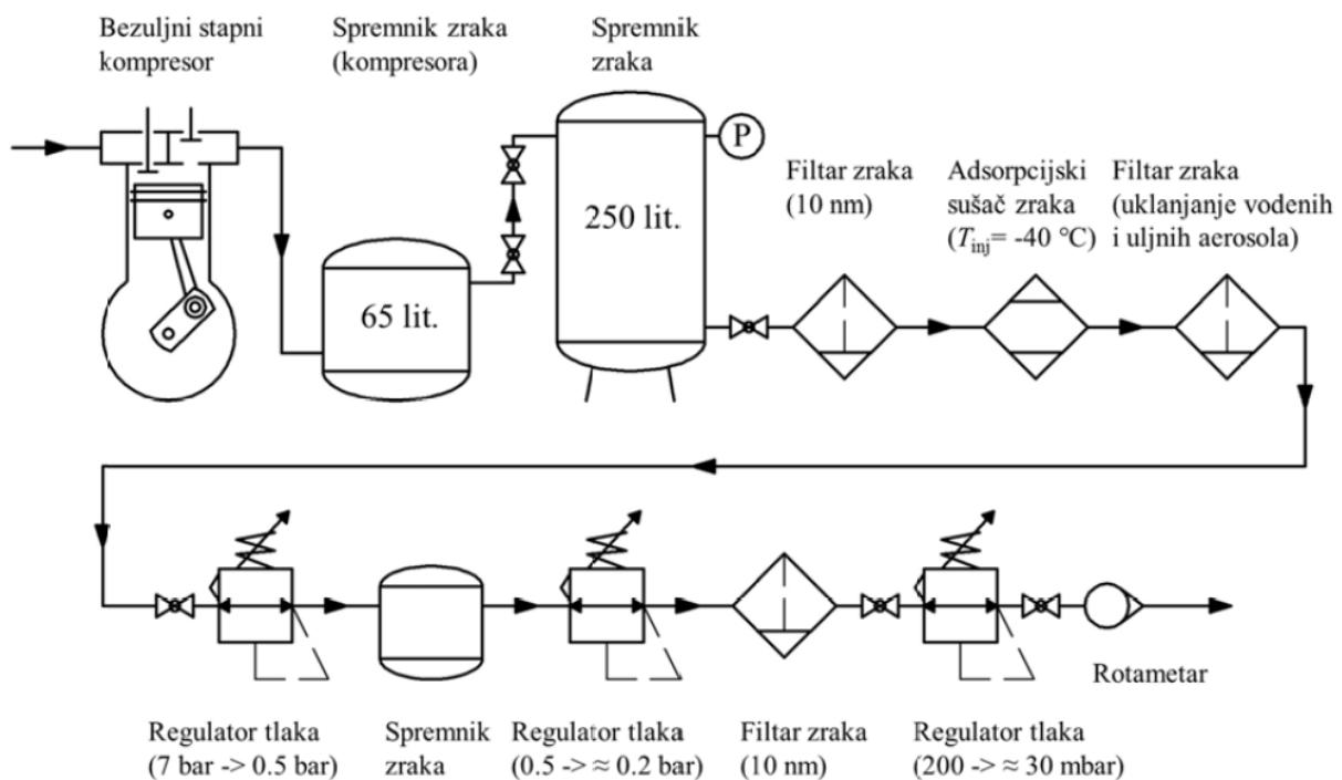
Slika 3. Shema pripreme čistog zraka [4]
