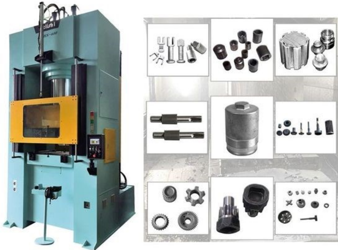
Slika 9. Preša za hladno kovanje u automobilskoj industriji [8]
