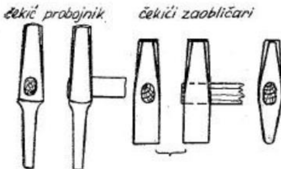
Slika 9. Čekić probojnik i čekić zaobljačar [1]
