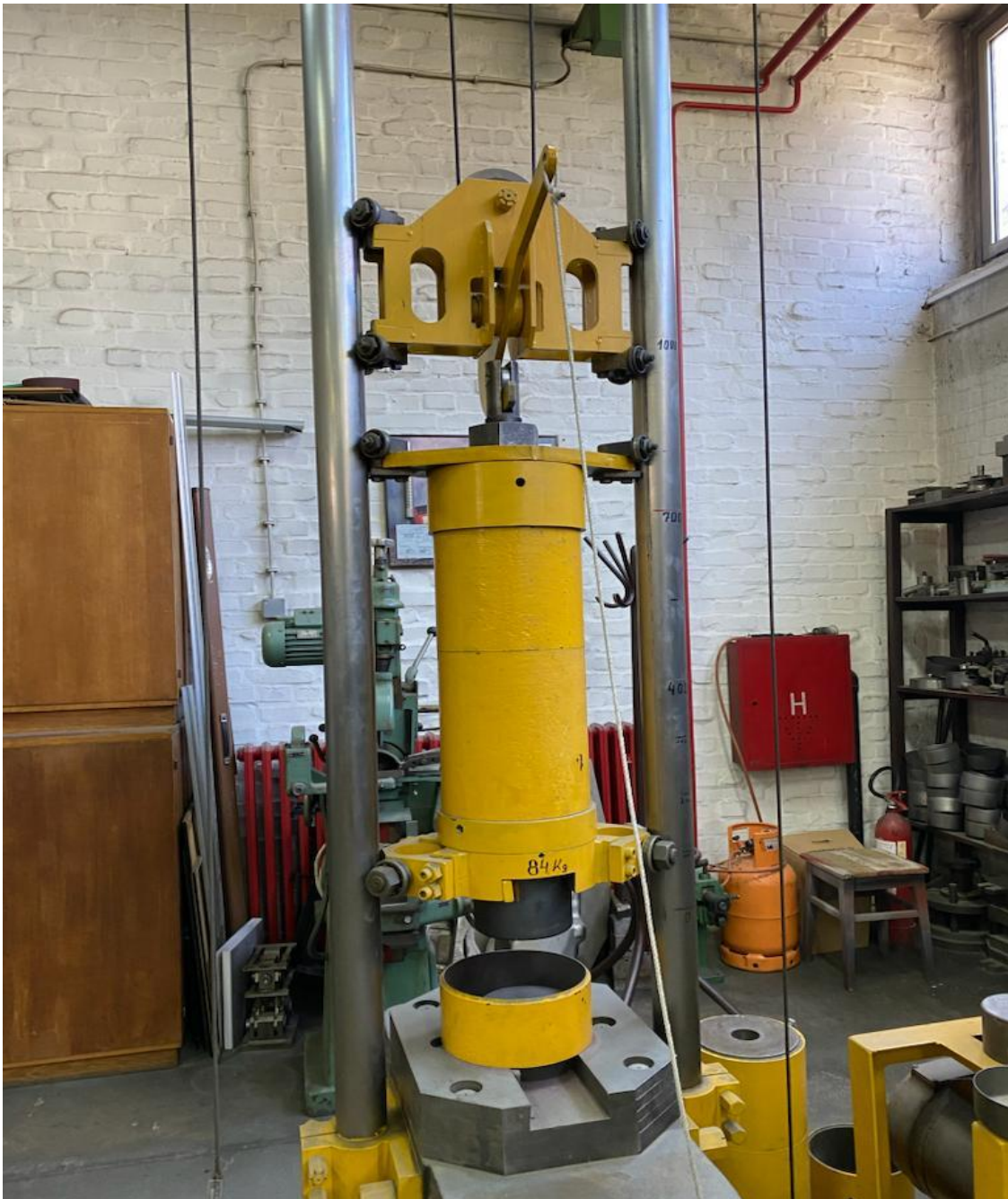
Slika 29. Gravitacijski bat s najvećom masom
