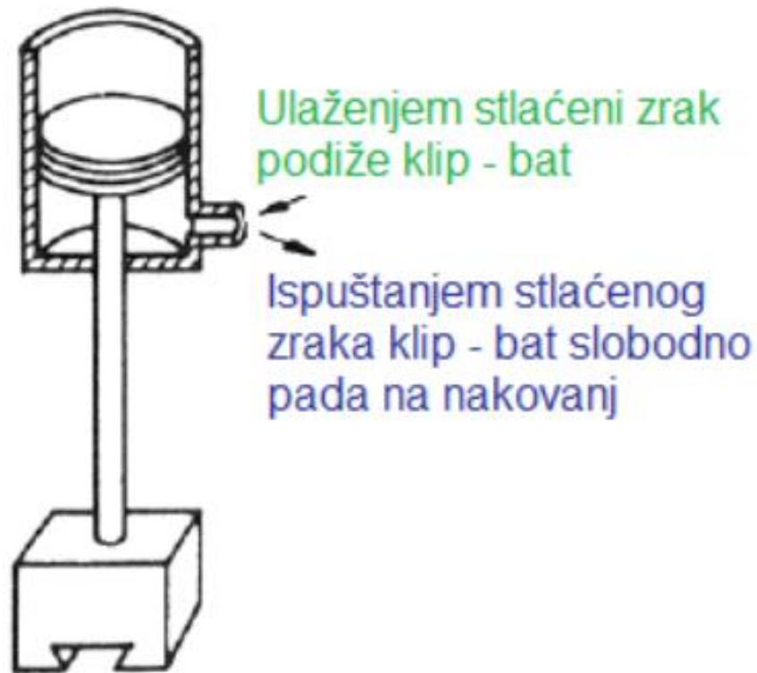
Slika 18. Jednoradni bat za slobodno kovanje [9]
