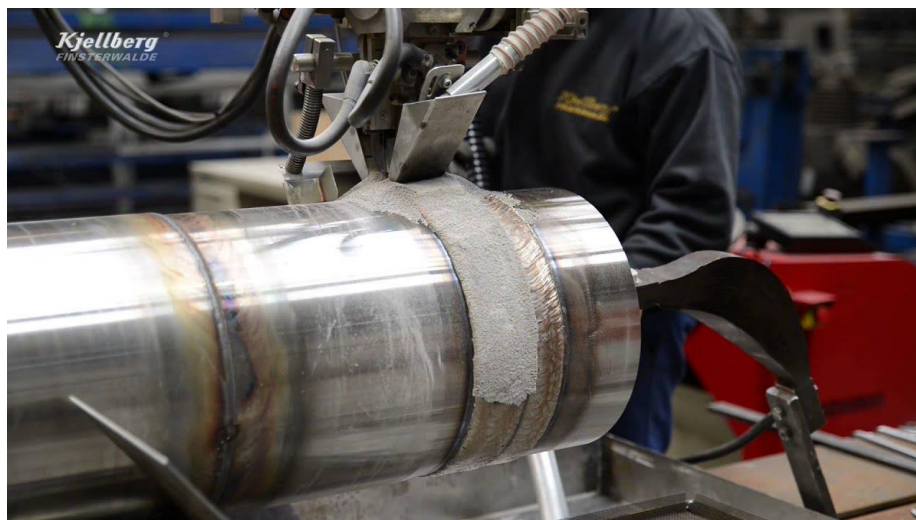
Slika 7. Navarivanje trakastom elektrodom [26]
