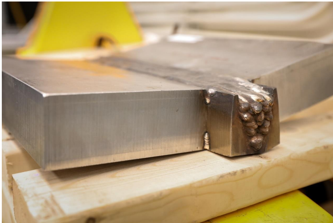
Slika 4. Deformacija nastala uslijed zavarivanja debelih ploča [18]
