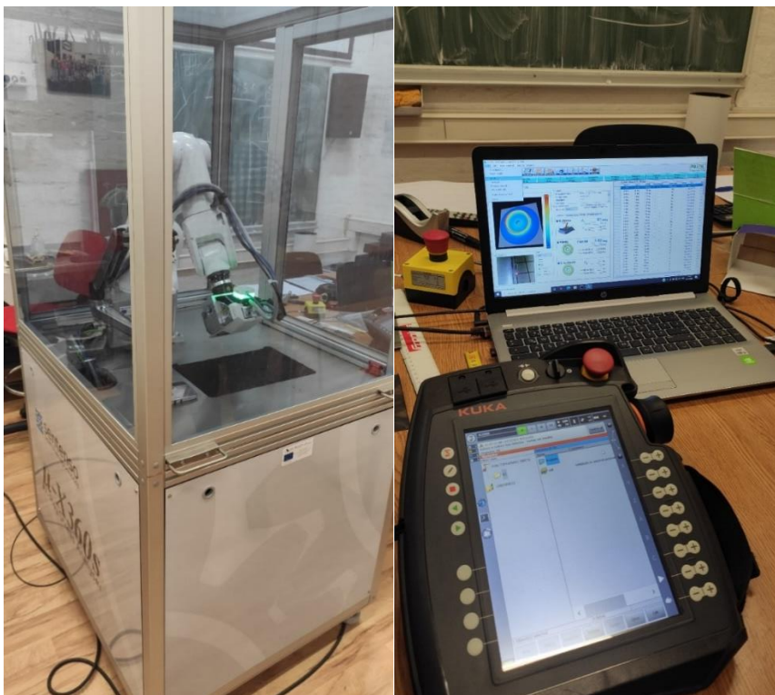
Slika 30. XRD uređaj sentenso \mu -X360s (lijevo) i pripadajuća upravljačka jedinica (desno)
