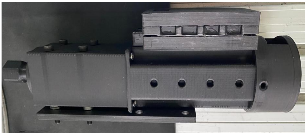
Slika 7.3. Sastavljeni nefunkcionalni model obradne glave
