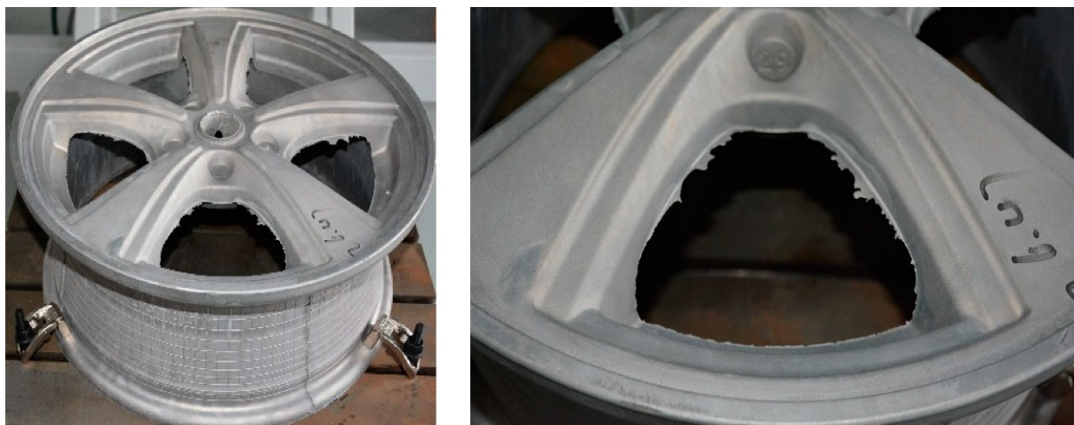
Slika 1.1. Prikaz srhova na neobrađenom aluminijskom naplatku [2]
