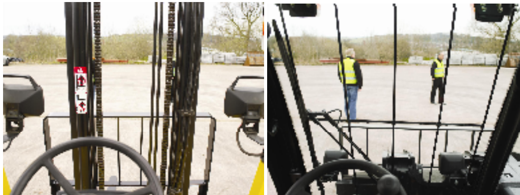
Slika 2.10. Frontalno vidno polje operatera viličara : lijevo – klasična izvedba (bez kabine, sa stupovima - jarbolom), desno – izvedba sa teleskopskom granom (sa kabinom)
