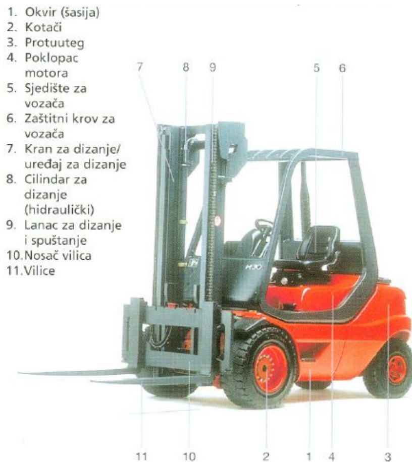
Slika 2.2. Prikaz glavnih dijelova viličara (čelna izvedba) [2]
