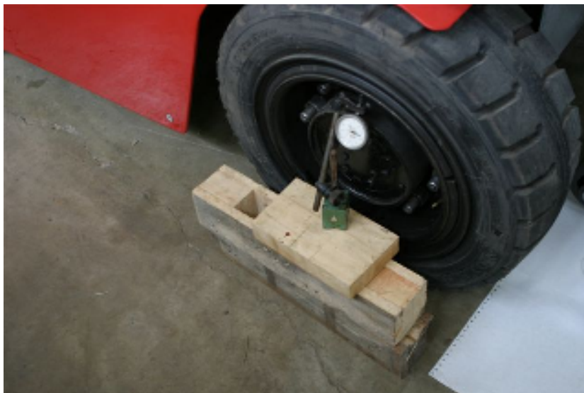
Slika 3.6. Postupak mjerenja statičkog progiba prednje gume viličara
