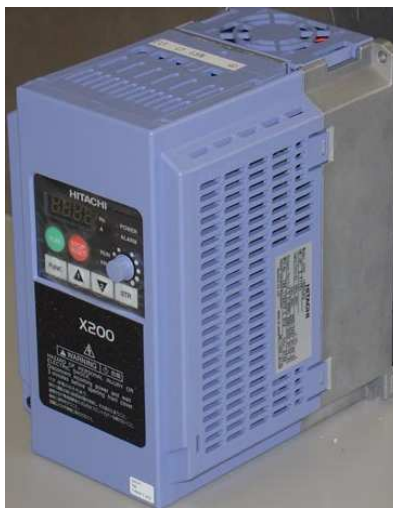
Slika 38. Inverterski regulator frekvencije [13]
