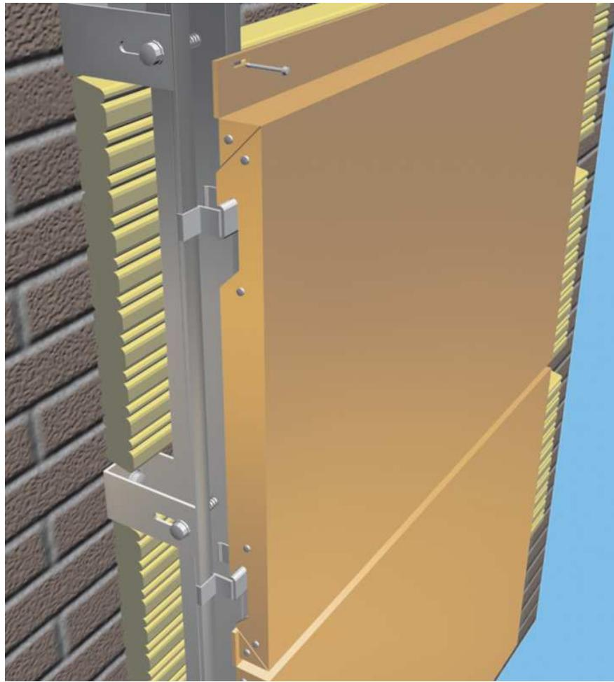
Slika 15. Izgled Larson PE ploče sa podkonstrukcijom
