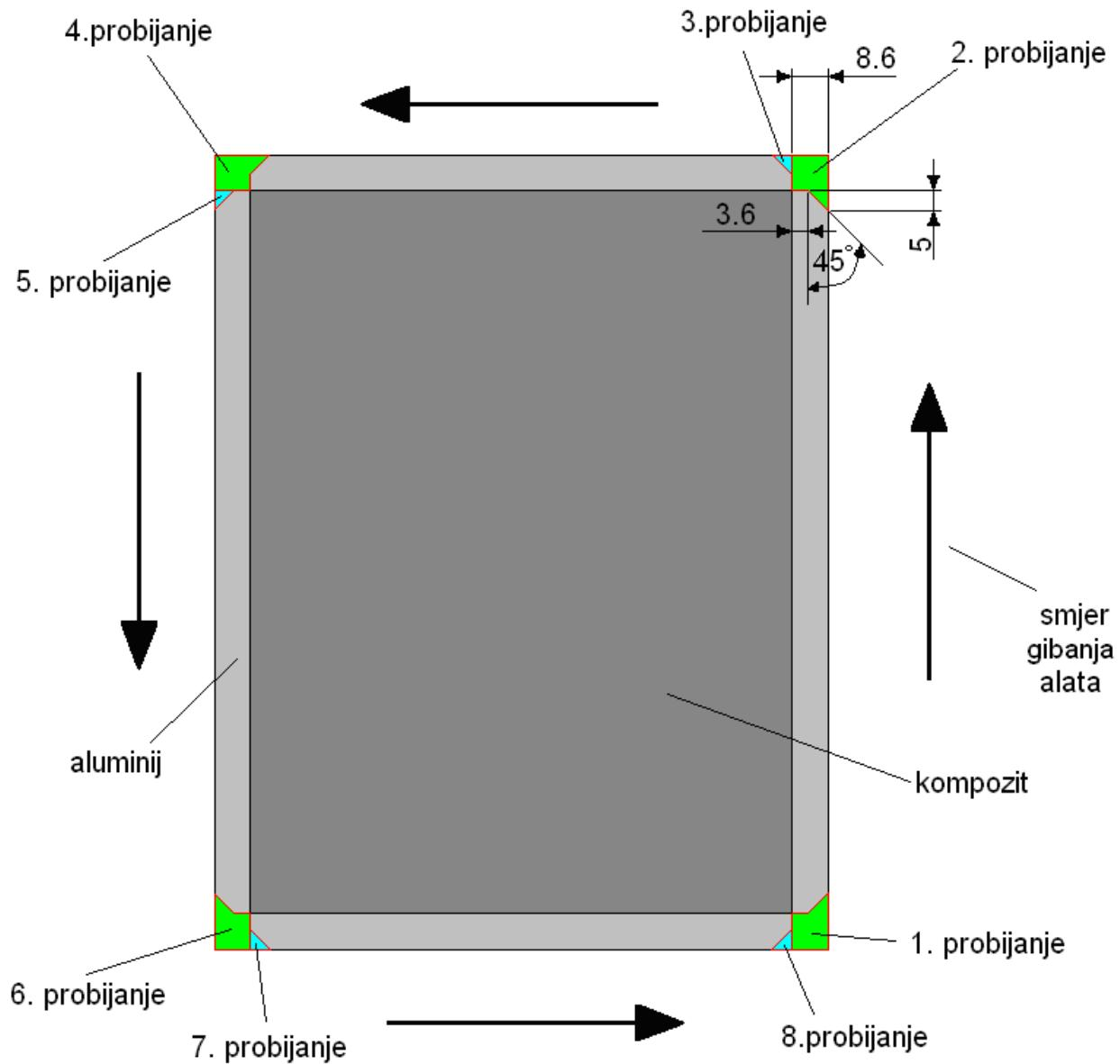
Slika 44. Redoslijed i dimenzije probijanja kompozitne ploče
