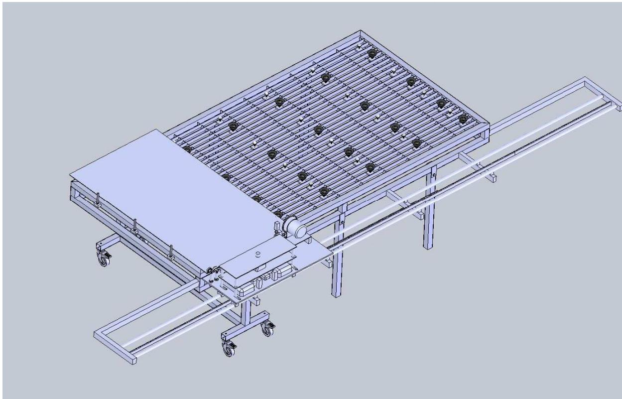
Slika 23. Izgled stroja za glodanje i savijanje
