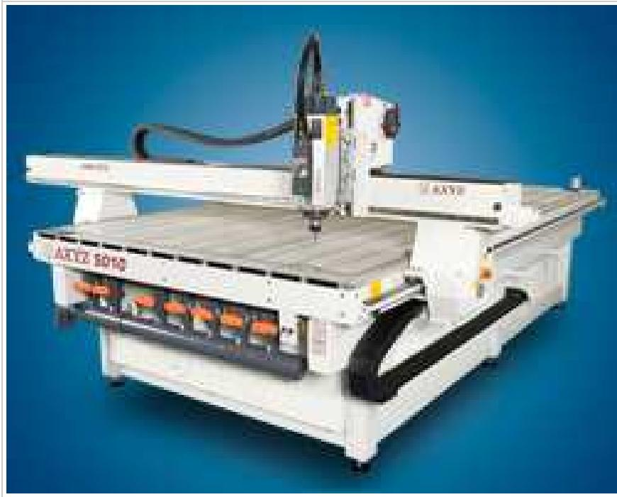
Slika 12. Stroj za obradu kompozitnih ploča: CNC Router AXYZ 5010 [6]
