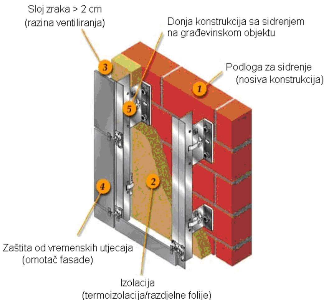
Slika 3. Prikaz sustava ovješene i ventilirane fasade [1]
