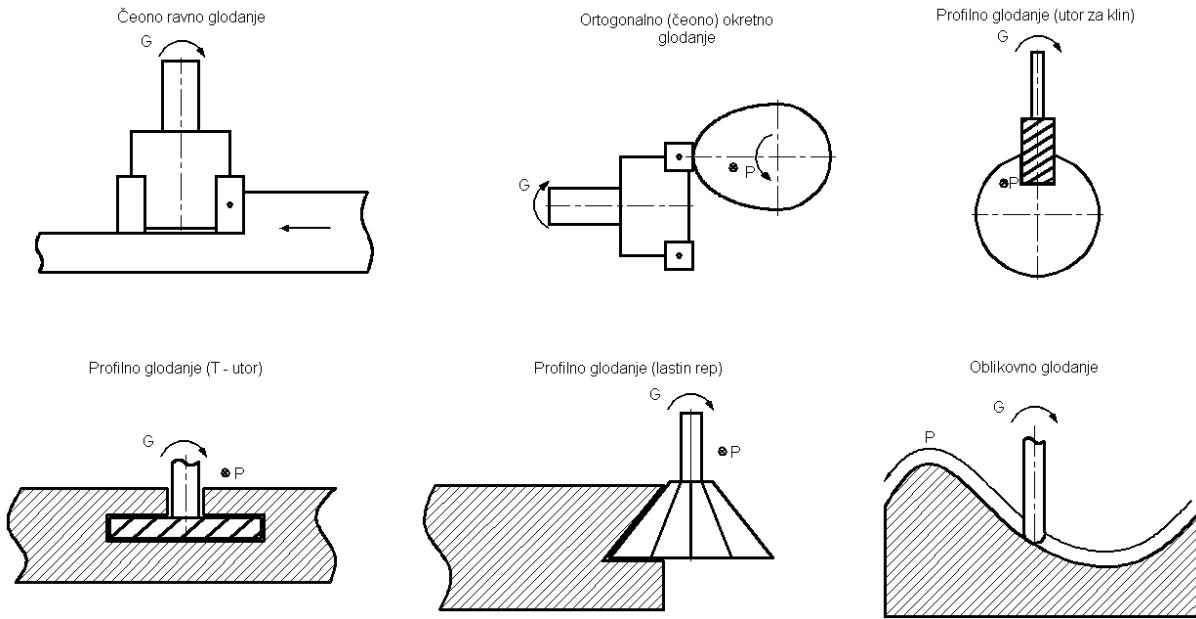
Slika 7. Podjela glodanja po obliku obrađene površine
