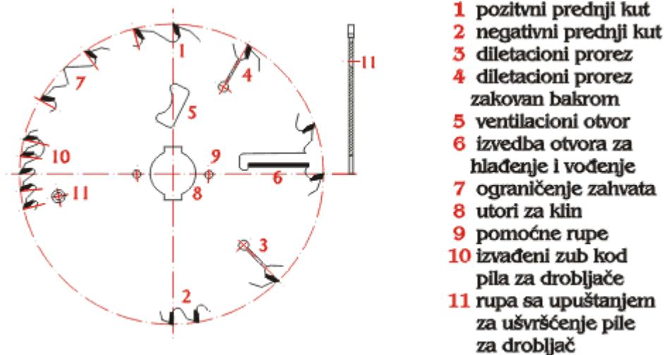
Slika 28. Odabir izvedbe kružne pile za glodanje [11]
