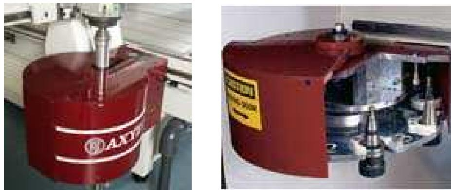
Slika 14. Sustav za automatsku izmjenu alata [6]
