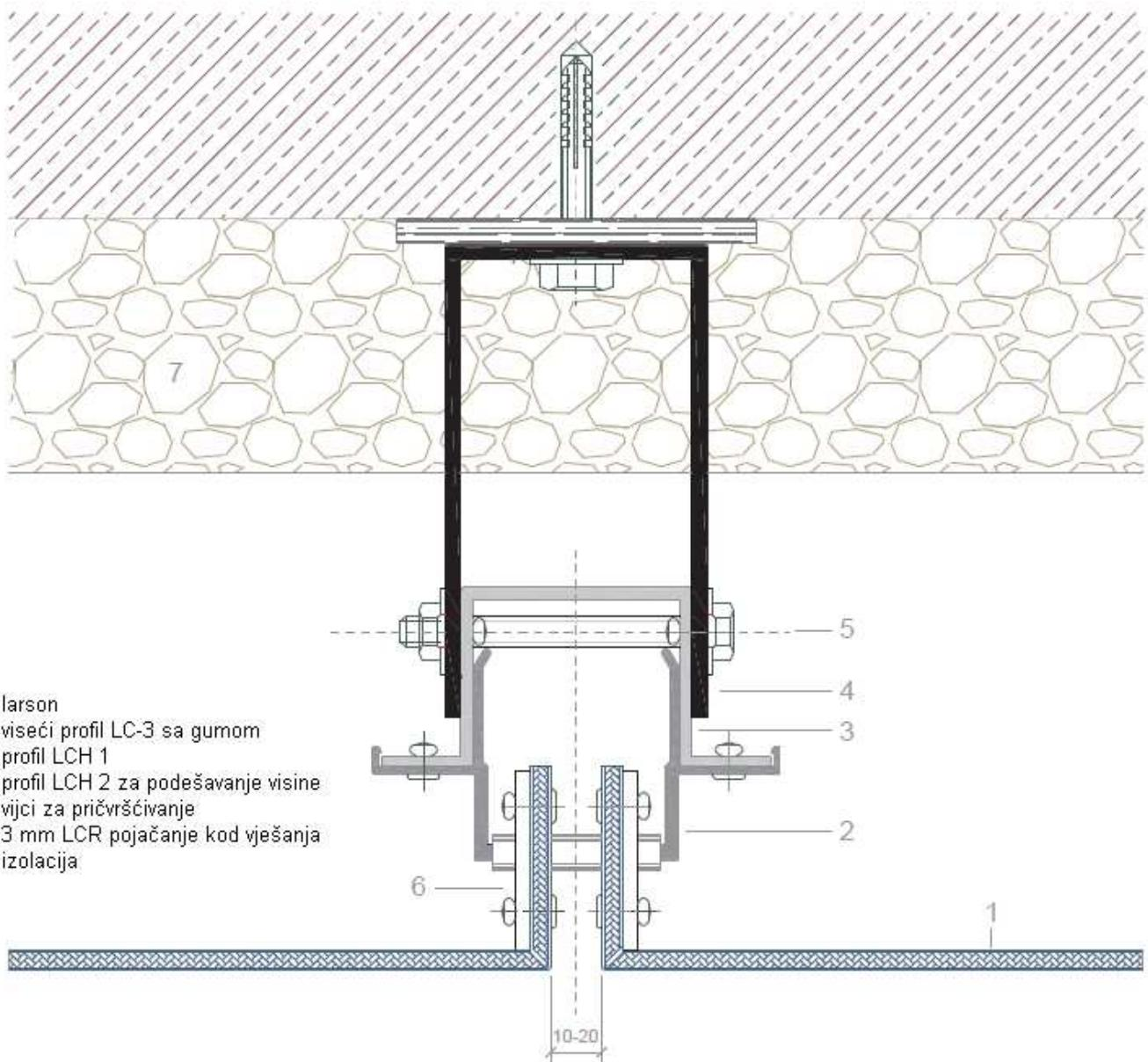
Slika 18. Detalj postavljanja ploče na podkonstrukciju - pogled odozgo
