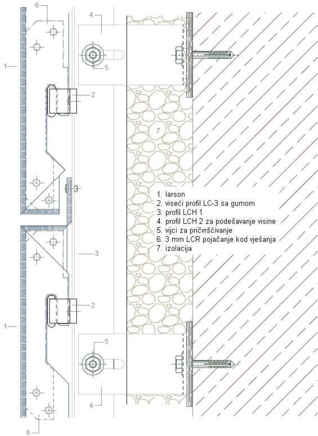
Slika 19. Detalj postavljanja ploče na podkonstrukciju-bočni pogled
