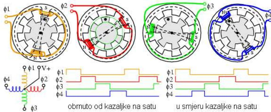
Slika 52. Jednofazna pobuda za zakretanje četverofaznih koračnih motora [17]
