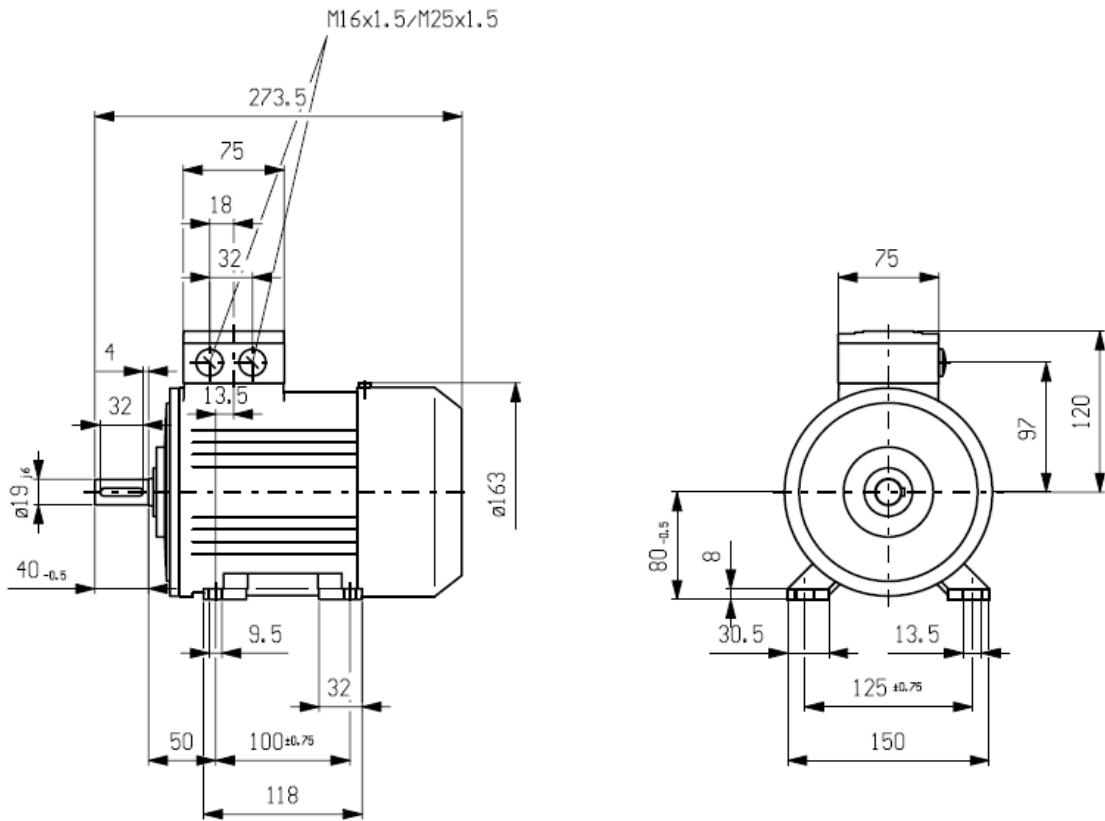
Slika 37. Dimenziije motora Siemens 1LA7 083-2AA-10 [12]
