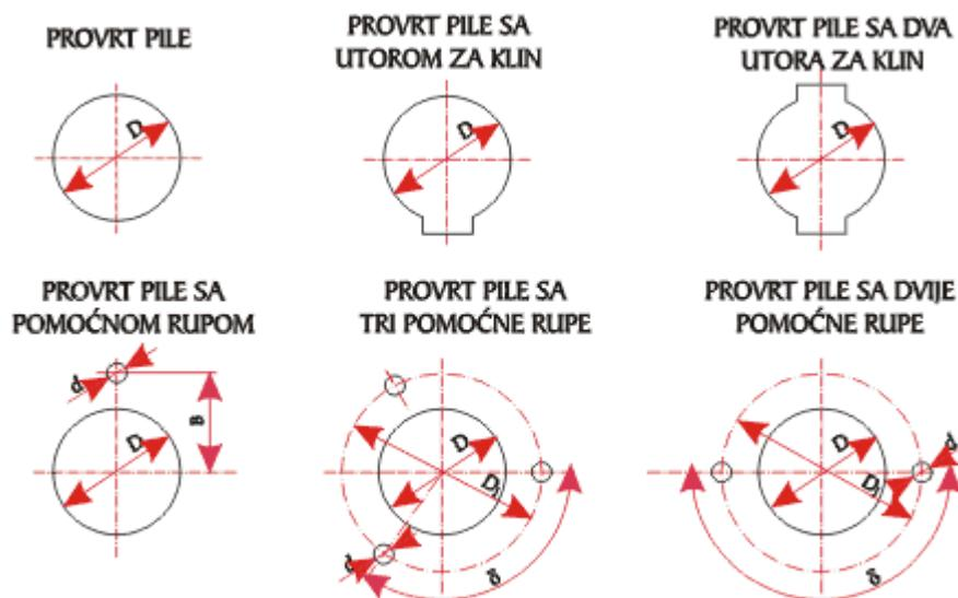
Slika 29. Najčešći oblici provrta kružnih pila za glodanje [11]
