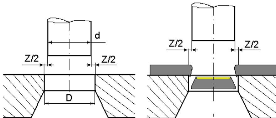
Slika 41. Zračnost između noža i rezne ploče [14]
