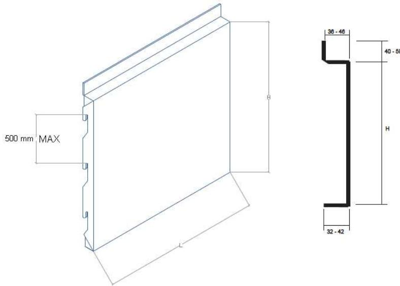
Slika 16. Ploča sa standardnim mjerama rubova
