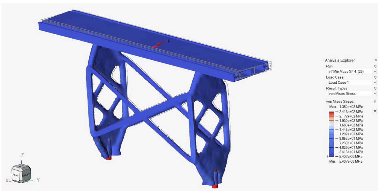
Slika 51: :von Mises- Minimiranje mase ( F=3 )- smjer okomit na smjer kretanja vlaka
