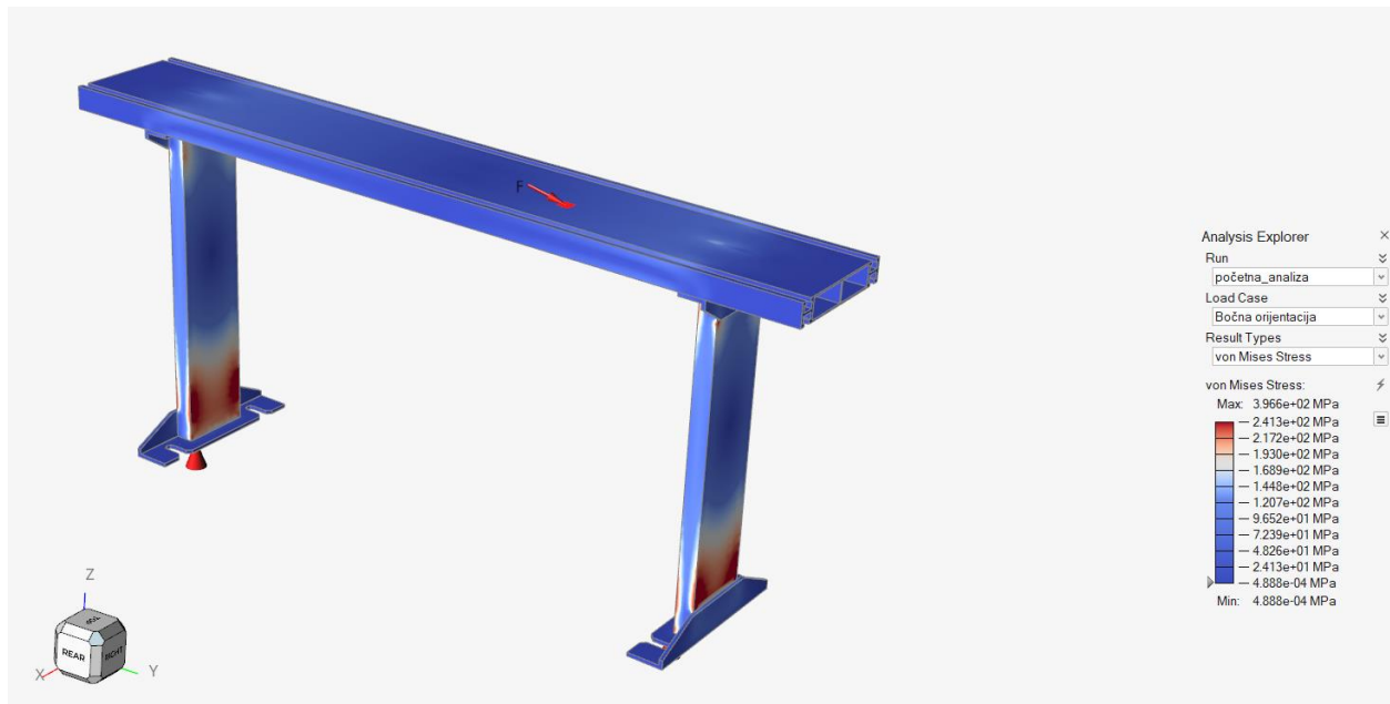
Slika 34: von Mises- orijentacija okomita na smjer kretanja vlaka
