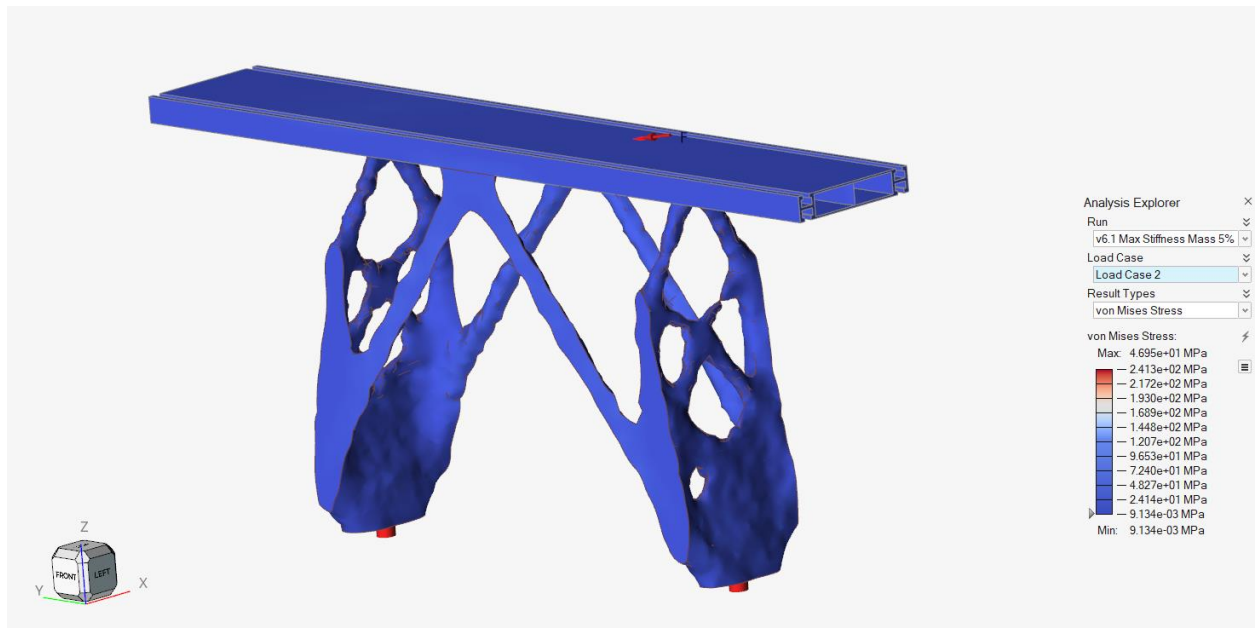
Slika 49: von Mises- Maksimiranje krutosti (5%)- smjer okomit na smjer kretanja vlaka
