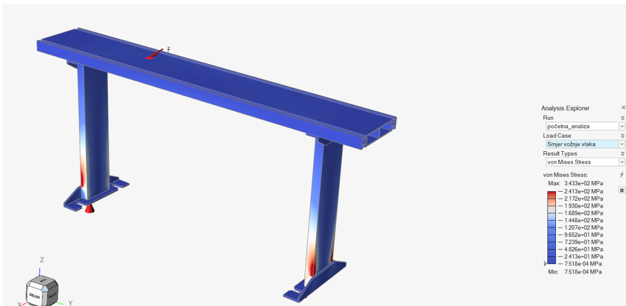
Slika 33: von Mises- početna analiza- smjer kretanja vlaka
