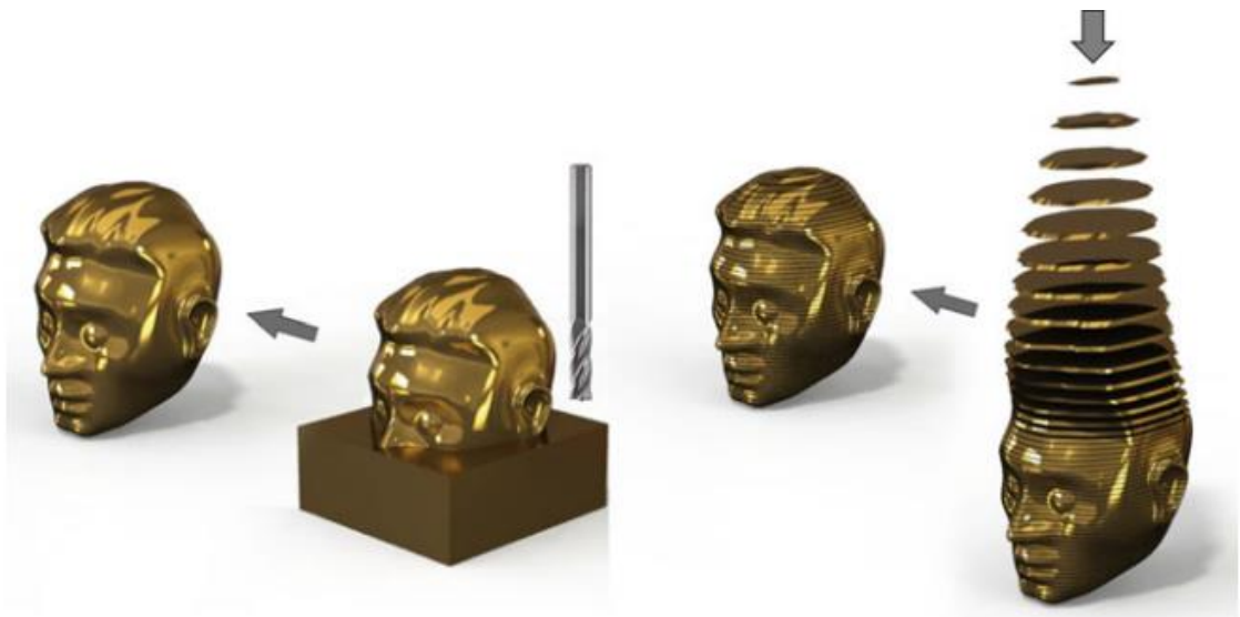
Slika 1: Razlika između substraktivne (lijevo) i aditivne proizvodnje (desno) [1]
