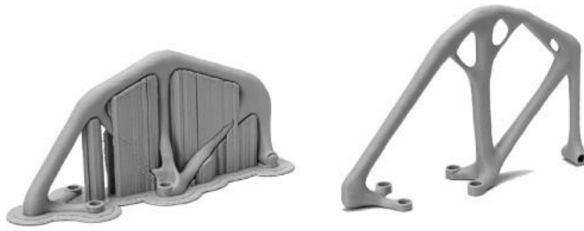
Slika 23: Količina suporta prije i nakon i TO [13]
