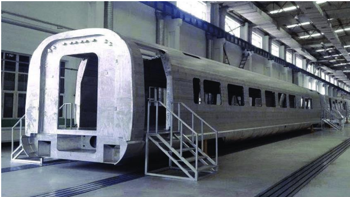
Slika 26: Konstrukcija vlaka od aluminijskog [18]
