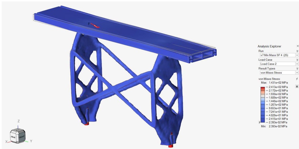
Slika 53: von Mises- Minimiranje mase ( F=4 )- smjer okomit na smjer kretanja vlaka
