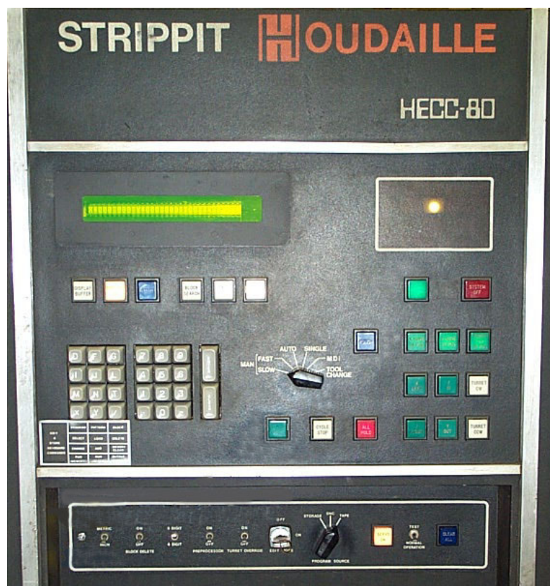
Slika 3.1 Upravljačka naprava iz '70-ih godina [9]
