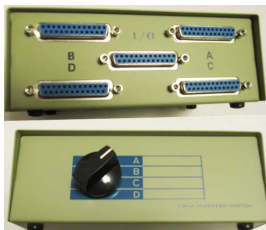
Slika 3.8 Primjer mehaničke preklopke sa 4 COM priključka [15]
