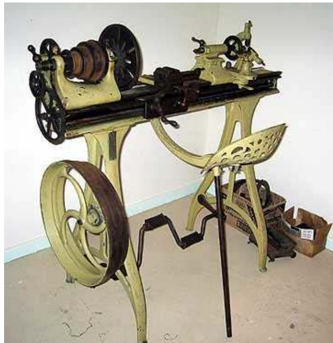
Slika 2.1 Jedan od prvih tokarskih strojeva, pokretan ljudskom snagom [2]
