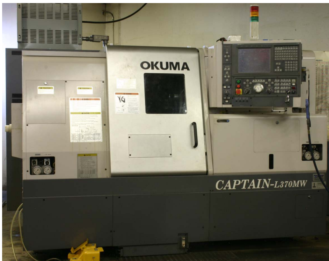
Slika 2.2 Suvremeni CNC tokarski obradni centar [3]
