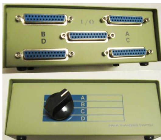
Slika 3.8 Primjer mehaničke preklopke sa 4 COM priključka [15]
