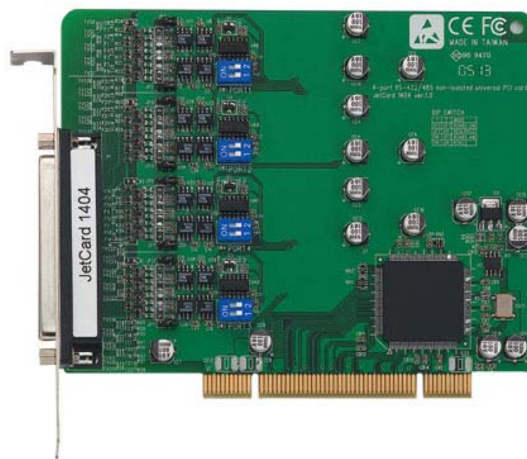
Slika 3.7 PCI kartica za dodavanje COM priključaka osobnom računalu [15]
