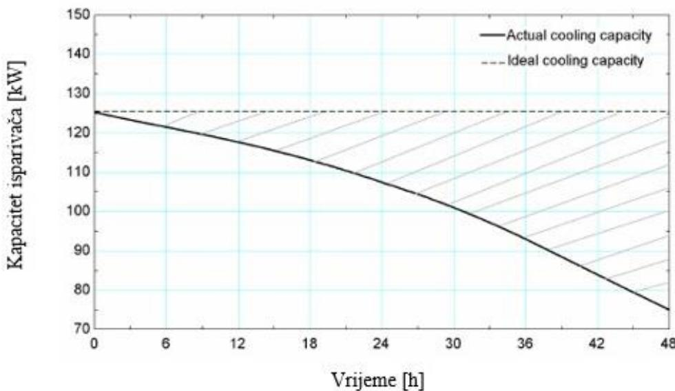
Slika 37 Gubitak zbog pada kapaciteta isparivača [12]
