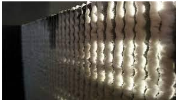
Slika 12 Porozna struktura leda [1]
