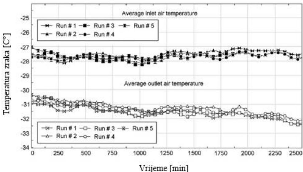
Slika 18 Ulagana i izlagana temperatura zraka u ovisnosti o vremenu rada [13]
