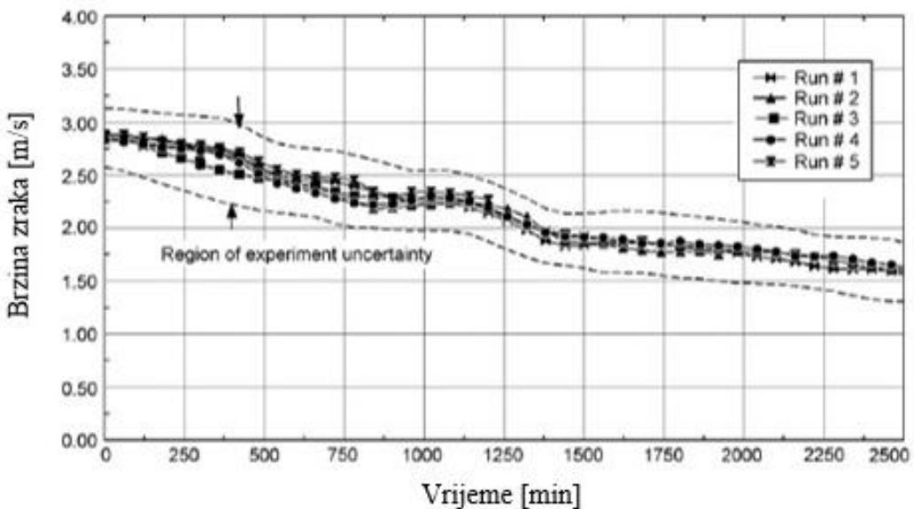
Slika 16 Brzina strujanja zraka na izlazu iz isparivača [13]
