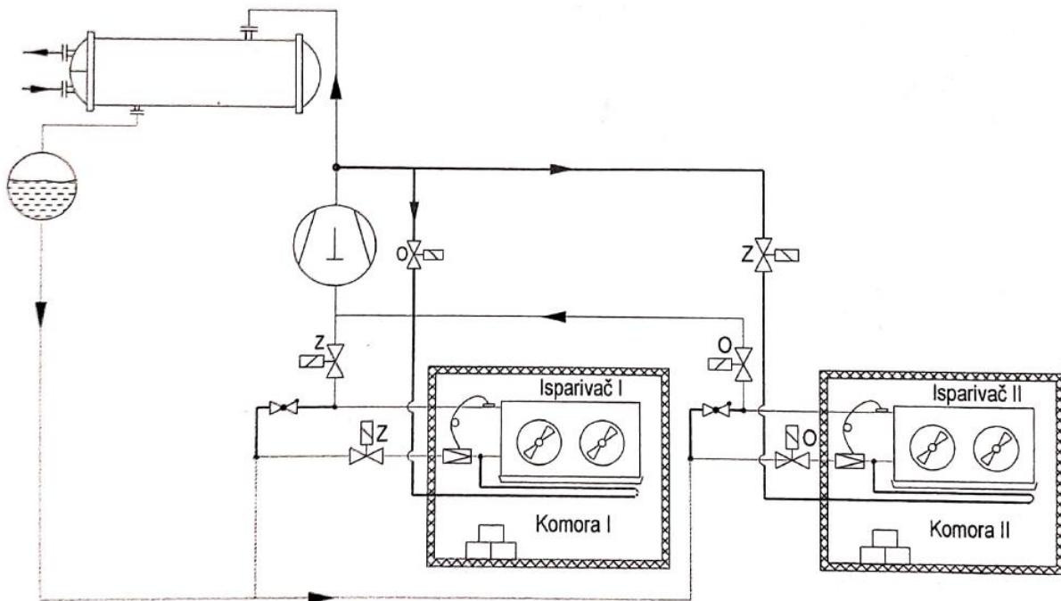
Slika 22 Shema odleđivanja isparivača Komore I vrućim parama radne tvari
