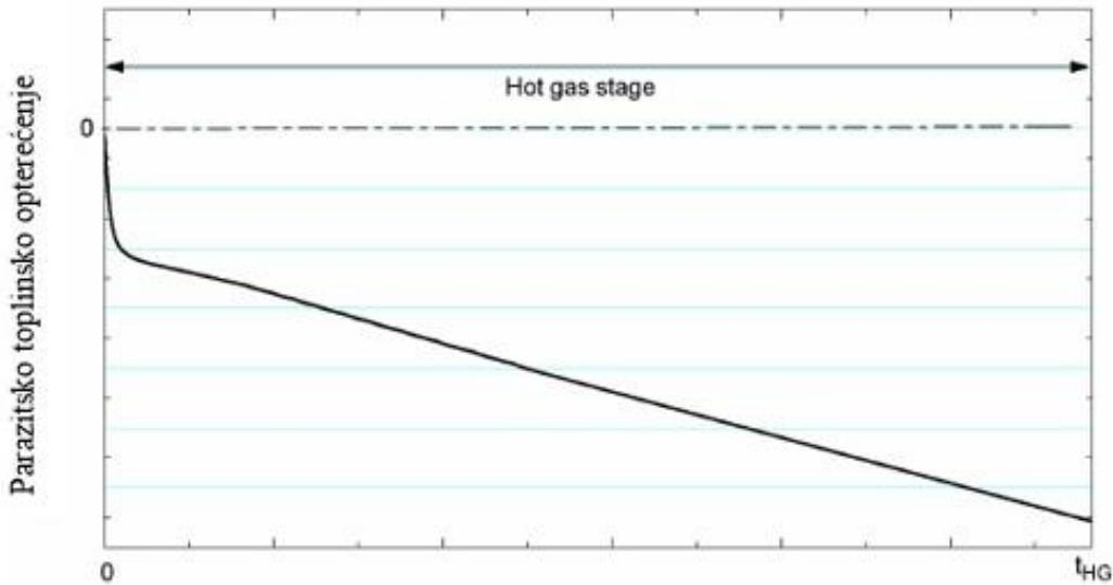
Slika 38 Parazitsko toplinsko opterećenje tijekom odleđivanja isparivača [12]
