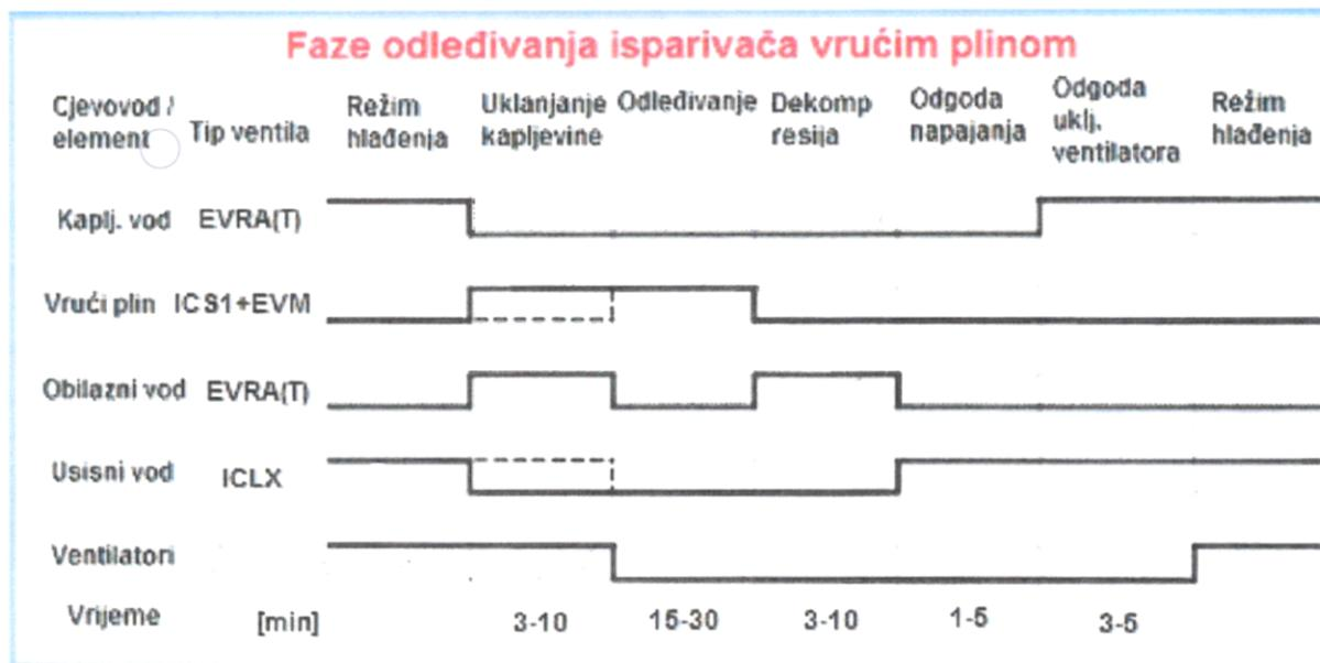
Slika 24 Prikaz faza odleđivanja isparivača vrućim plinom
