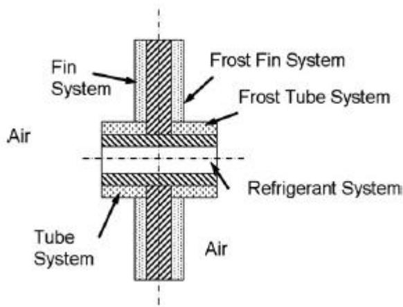
Slika 27 Dijelovi modela [6]
