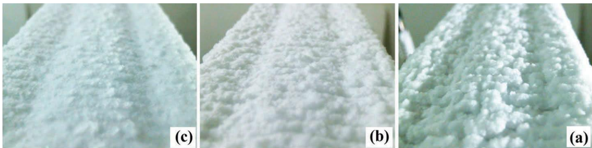
Slika 14 Usporedba strukture leda pri različitim temperaturama isparavanja [1]
