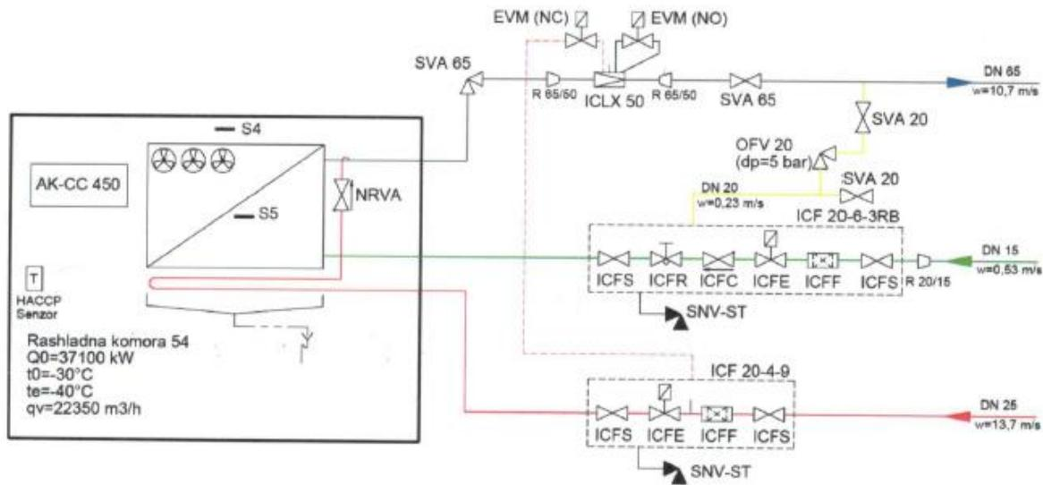
Slika 41 Shema regulacije sustava odleđivanja isparivača [4]
