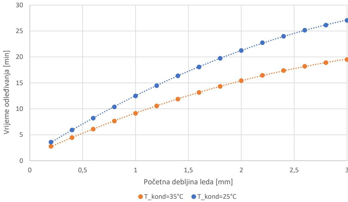
Slika 36 Ovisnost vremena odleđivanja o temperaturi kondenzacije
