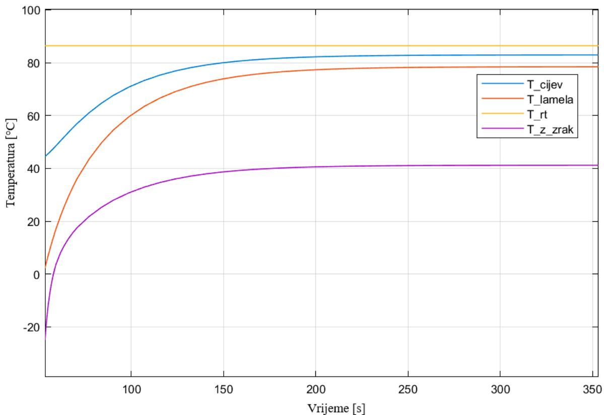
Slika 31 Kretanje temperatura tijekom faze odleđivanja lamele
