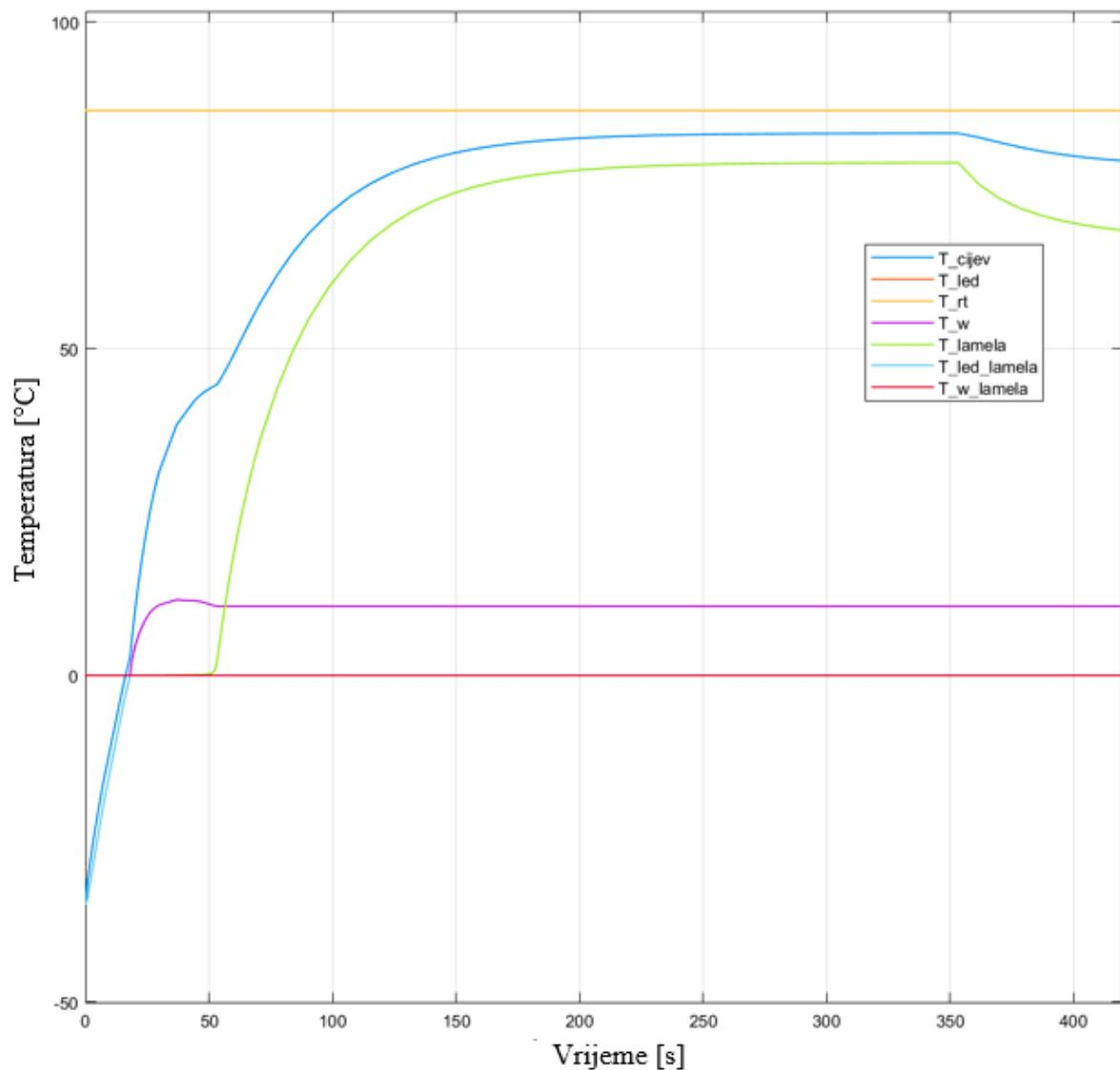
Slika 33 Kretanje temperatura tijekom cijelog procesa odleđivanja
