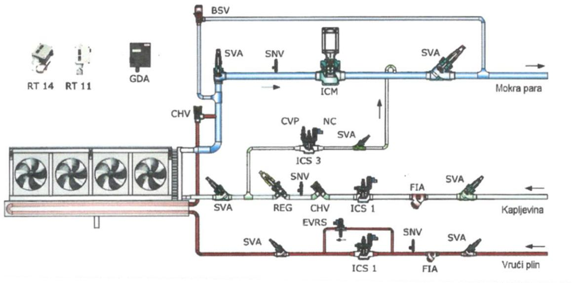
Slika 23 Shema sustava s odleđivanjem isparivača vrućim parama radne tvari [4]
