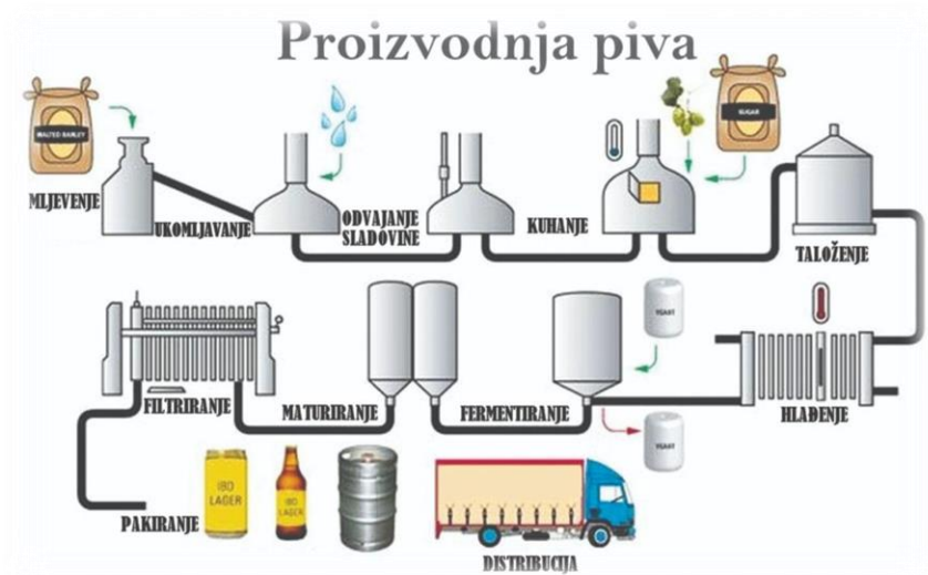
Slika 24 Postupak proizvodnje piva [35]
