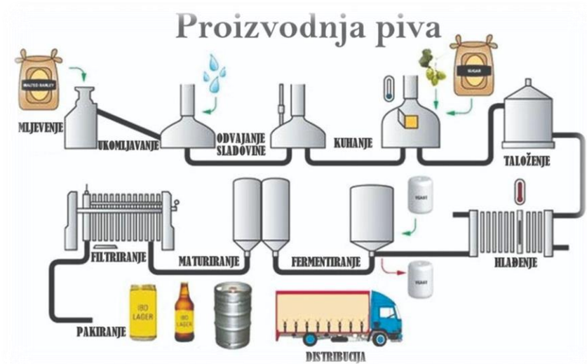
Slika 24 Postupak proizvodnje piva [35]
