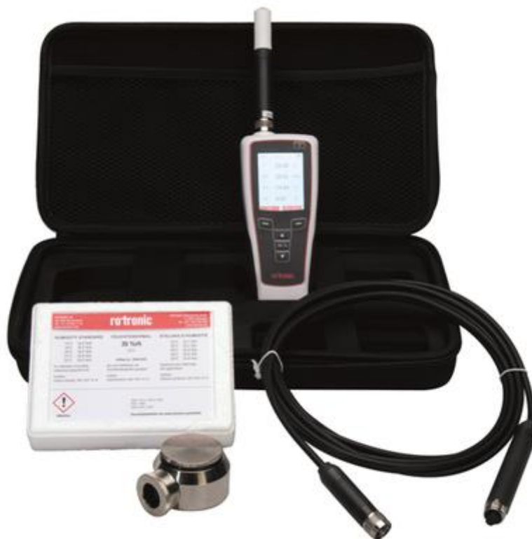
Slika 11. Rotronic Hygropalm HP32 s produžnim kabelom za osjetnik [5]
