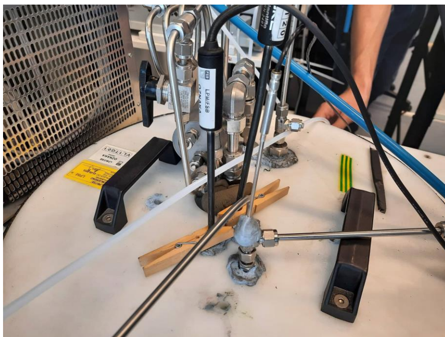
Slika 6. Poklopac primarnog generatora
