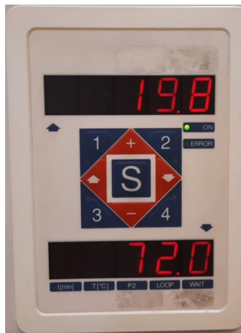
Slika 18. Regulator temperature i relativne vlažnosti zraka u komori
