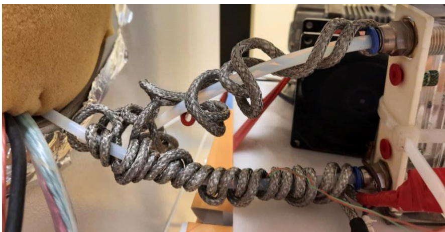
Slika 16. Izlazna cijev omotana grijačem
