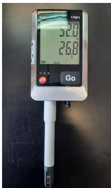
Slika 12. Instrument za praćenje uvjeta okoline
