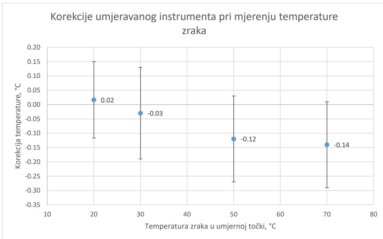
Slika 25. Korekcije umjeravanog instrumenta pri mjerenju temperature zraka
