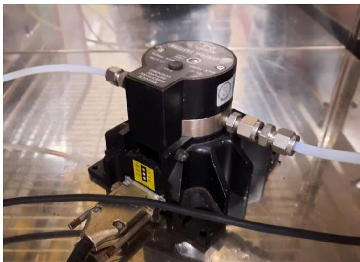
**Slika 17. Etalonski higrometar točke rose**
