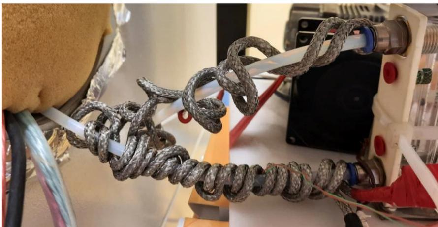
Slika 16. Izlazna cijev omotana grijačem
