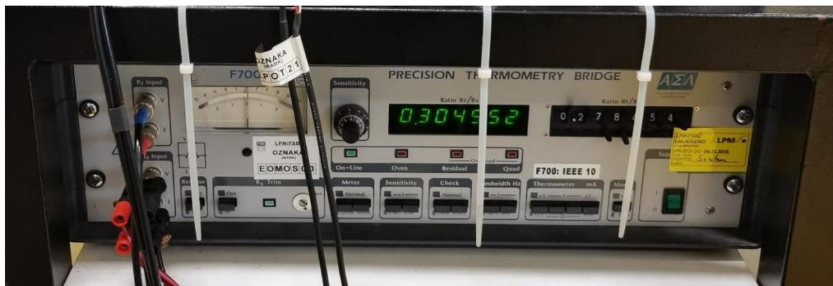
Slika 3. Termometrijski otpornički most
