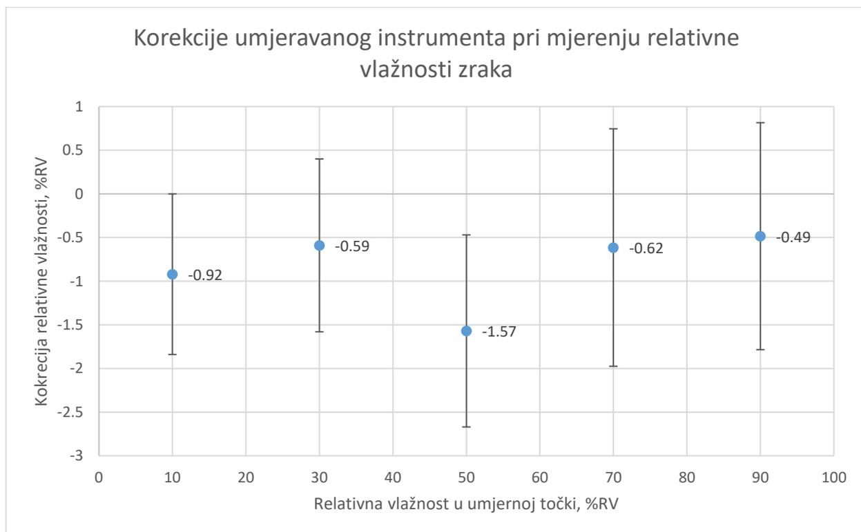
Slika 26. Korekcije umjeravanog instrumenta pri mjerenju relativne vlažnosti zraka
