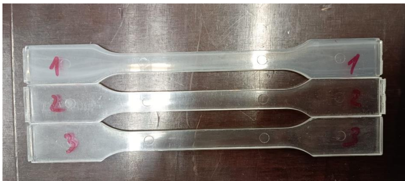
Slika 5.13. Ispitna tijela polistirena (PS)
