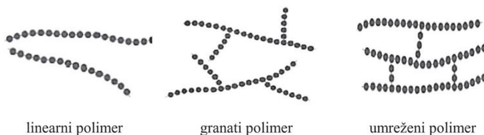
Slika 2.1. Prikaz tipova različitih polimernih molekula [3]
