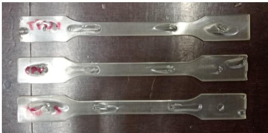
Slika 5.19. Ispitna tijela od poliuretanskog elastomera (TPU)
