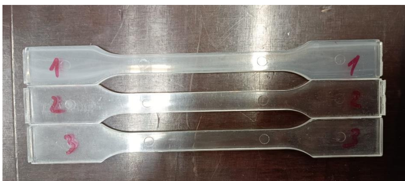
Slika 5.13. Ispitna tijela polistirena (PS)
