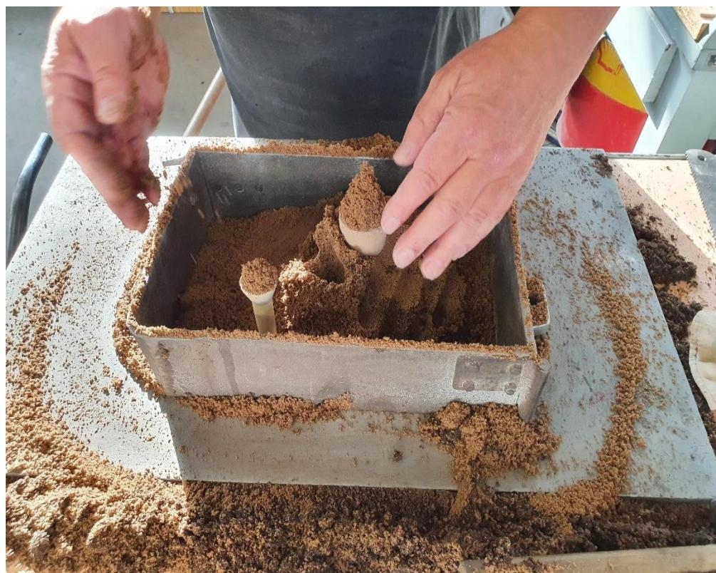
**Slika 56.** Nasipavanje kalupne mješavine
