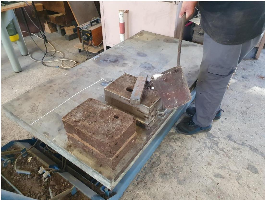
**Slika 66.** Lijevanje horizontalnih varijanti uljevnih sustava
