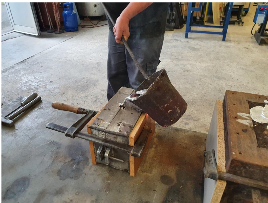
Slika 67. Lijevanje vertikalnih varijanti uljevnih sustava
