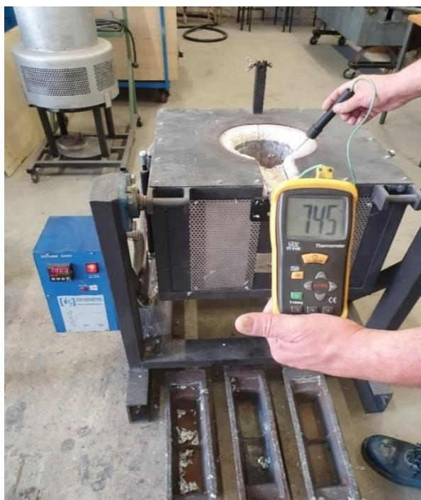
**Slika 63.** Temperatura taline u peći
