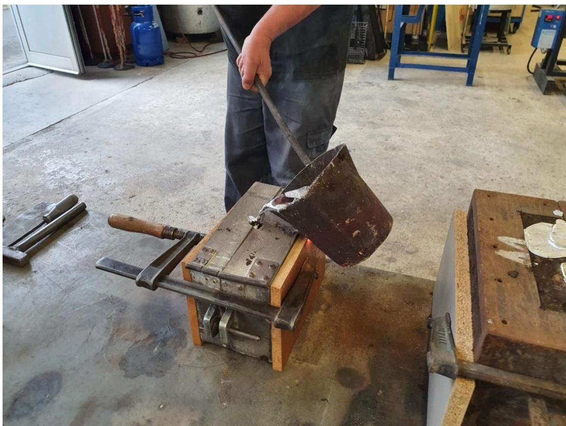
**Slika 67.** Lijevanje vertikalnih varijanti uljevnih sustava
