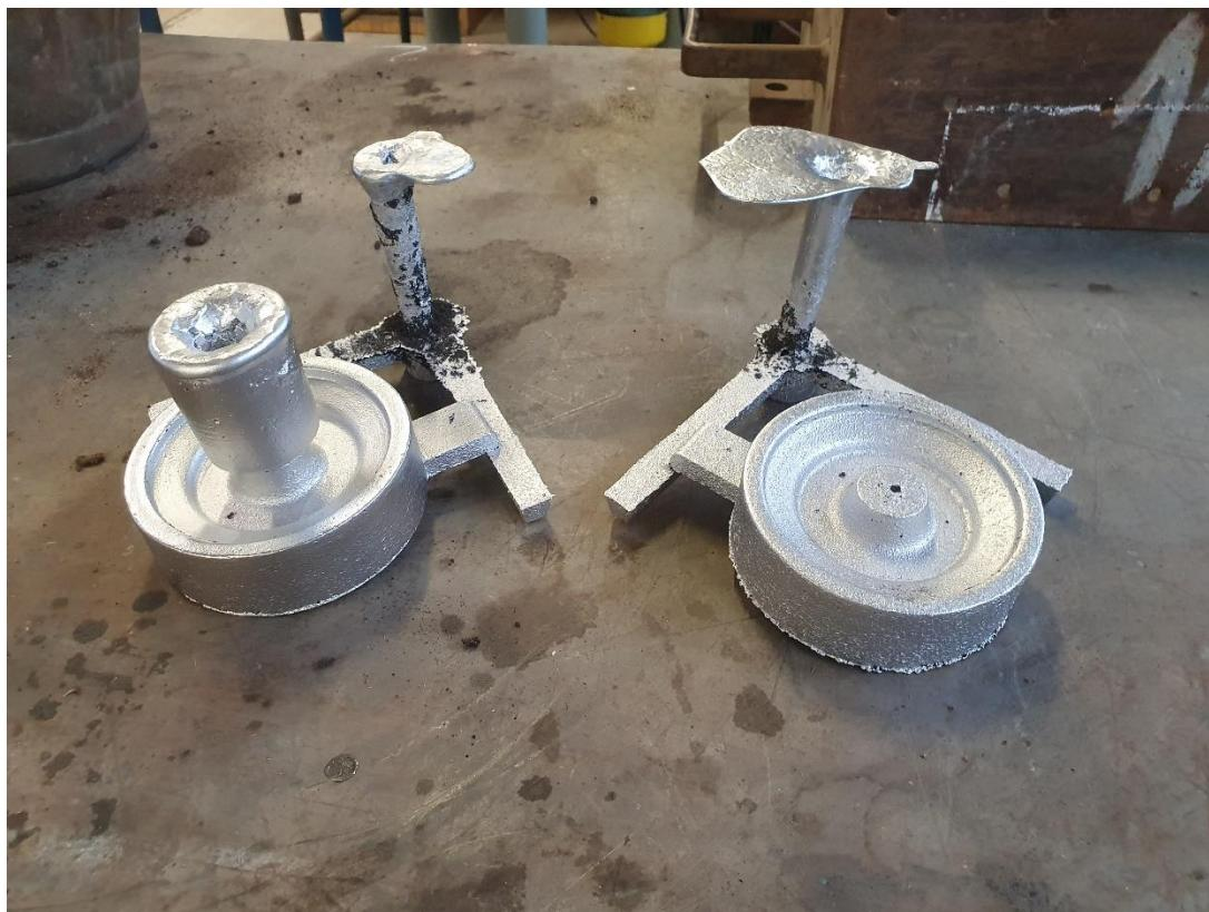
**Slika 69.** Izgled odljevka horizontalnih varijanti uljevnog sustava nakon hlađenja
