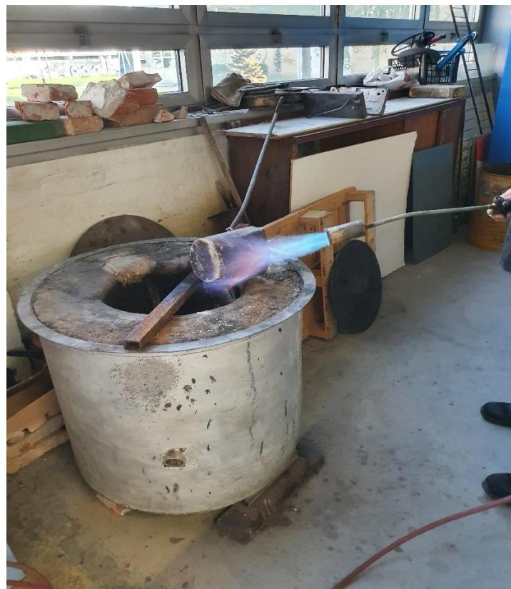
Slika 64. Zagrijavanje lonca za lijevanje
