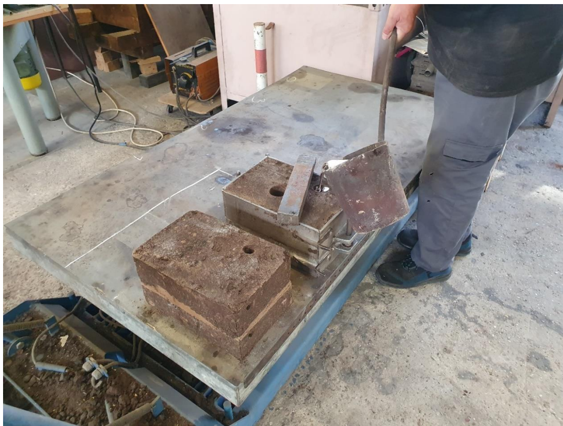
Slika 66. Lijevanje horizontalnih varijanti uljevnih sustava
