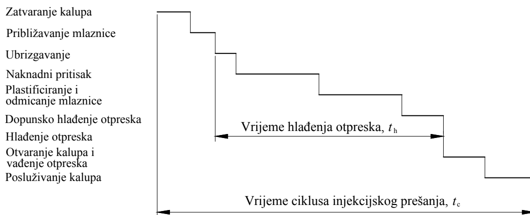
Slika 2.2. Faze ciklusa injekcijskog prešanja plastomera [1]
