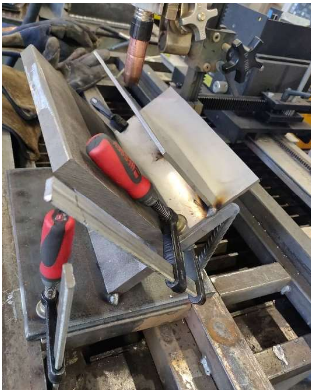
Slika 38. Položaj zavarivanja PA
