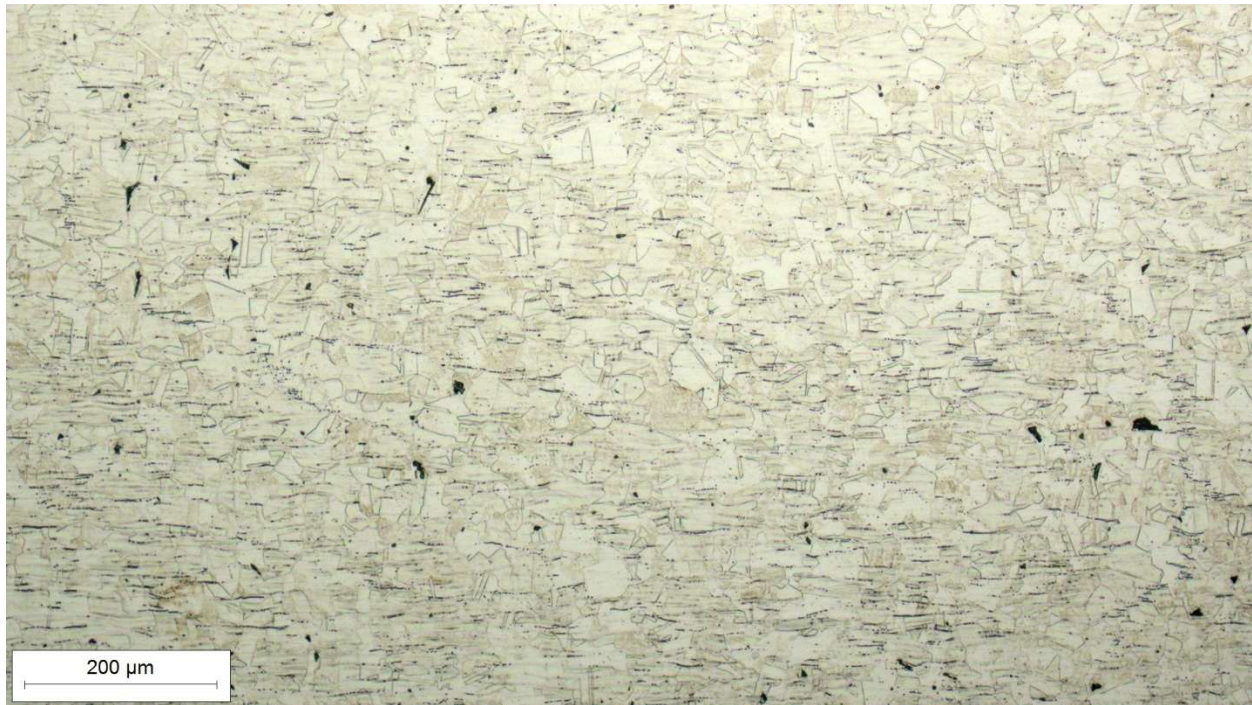
Slika 55. Mikrostruktura osnovnog materijala 1.4301 (AISI 304)
