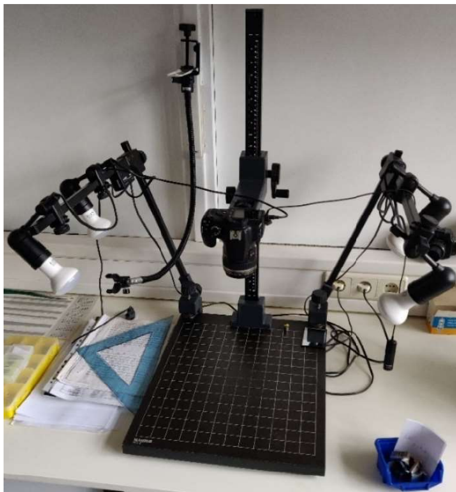
Slika 51. Radna stanica s osvjetljenjem i fotoaparatom
