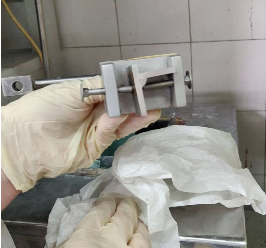
Slika 46. Uzorak nakon elektrokemijskog nagrivanja
