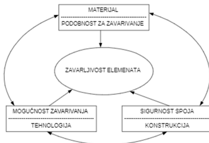
Slika 11. Zavarljivost metalnih materijala [8]
