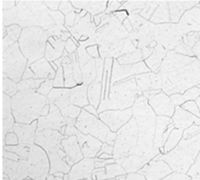
Slika 7. Mikrostruktura austenitnog čelika [1]
