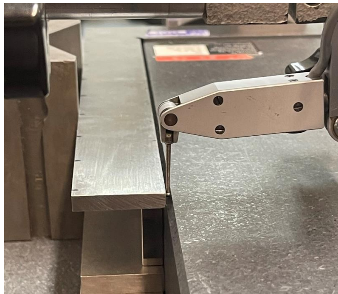
Slika 42 Mjerenje unutarnjeg kuta čeličnog kutnika
