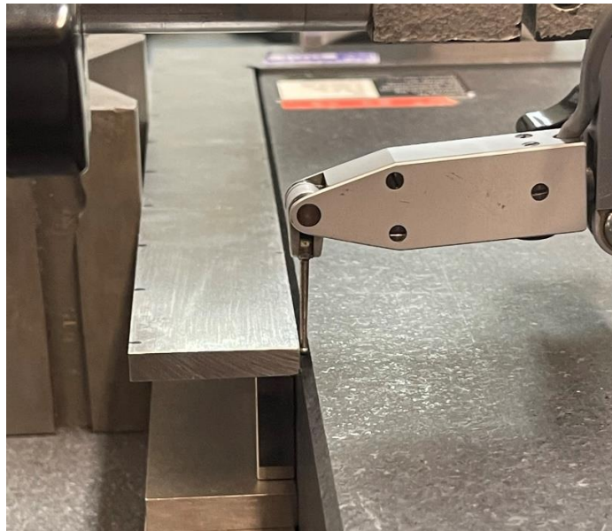
Slika 42 Mjerenje unutarnjeg kuta čeličnog kutnika
