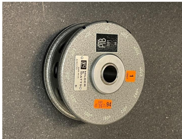
Slika 14 Kutni poligon (lab. oznaka KUT 12-298)
