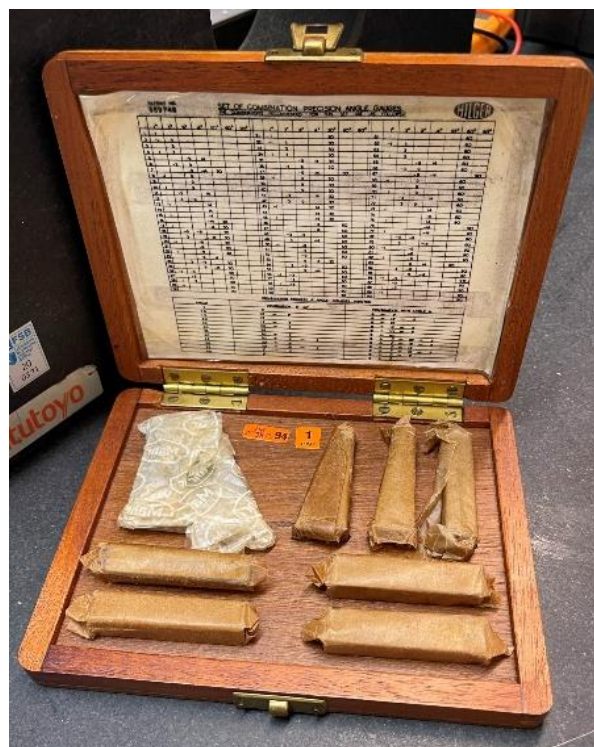
Slika 20 Garnitura kutnih graničnih mjerki (lab. oznaka KUT 9-295)
