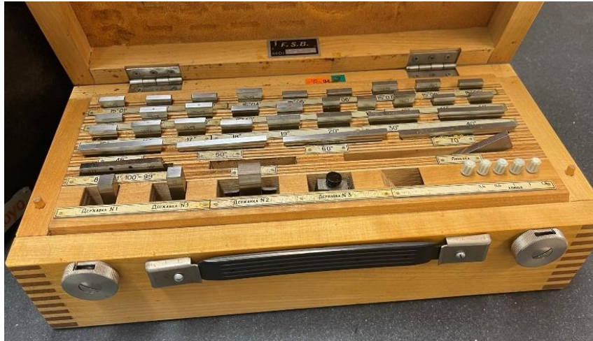
Slika 19 Garnitura kutnih graničnih mjerki (lab. oznaka KUT 13-301)
