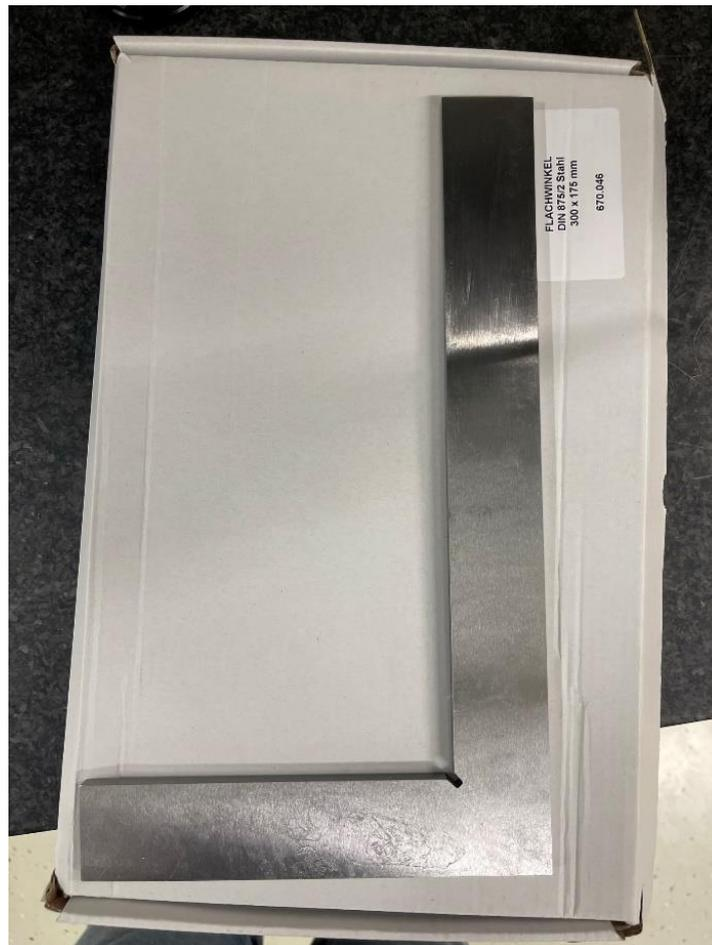
Slika 23 Čelični kutnik Flackwinkel DIN 875/2
