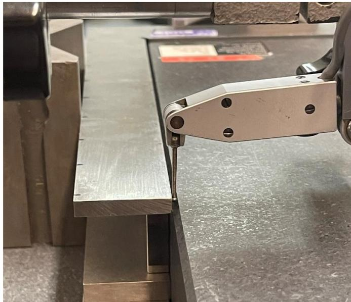
Slika 42 Mjerenje unutarnjeg kuta čeličnog kutnika
