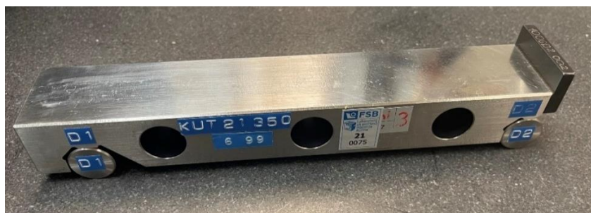
Slika 18 Sinus lineal (lab. oznaka KUT 21-350)
