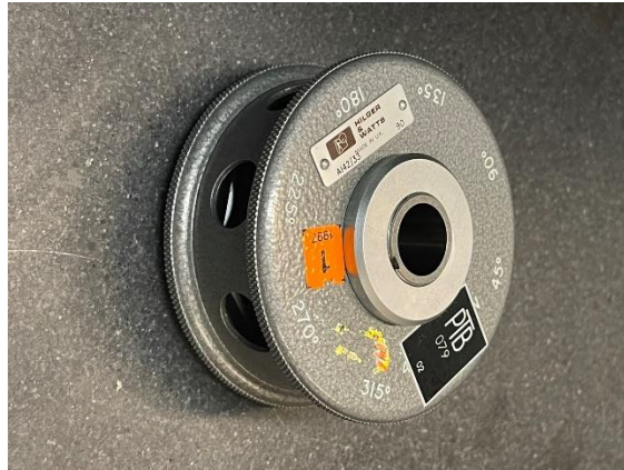
Slika 16 Kutni poligon (lab. oznaka KUT 10-296)
