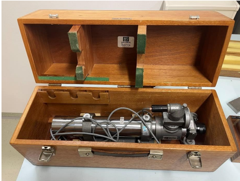
Slika 21 Autokolimator (lab. oznaka MU-23-199)
