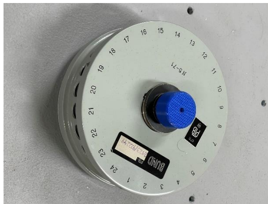
Slika 17 Kutni poligon (lab. oznaka KUT 2123/922249)
