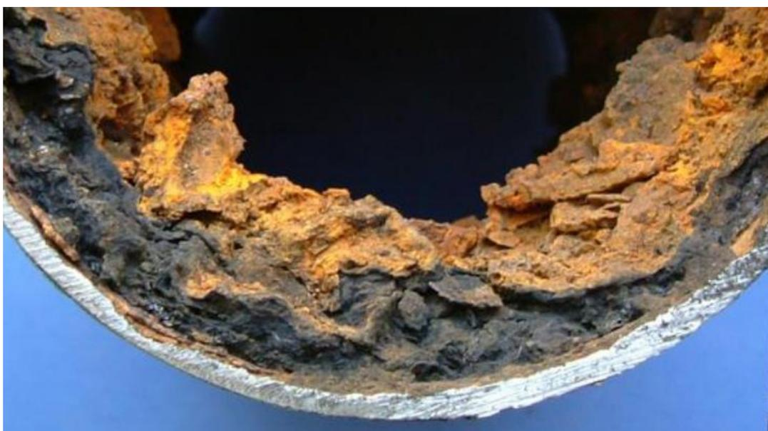
Slika 6. Korozijski produkti unutar cjevovoda tehnološke vode [10]
