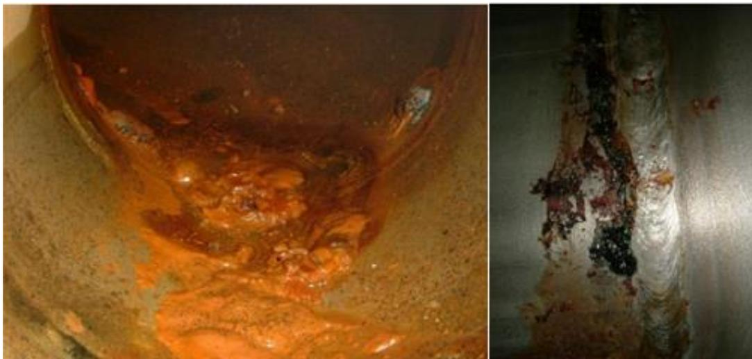
**Slika 8.** Nakupine u području zavarenih spojeva na unutarnjim stjenkama cjevovoda čelika AISI 304L (lijevo) i korozijski produkti i propuštanje vode na vanjskim stjenkama (desno) [10]
