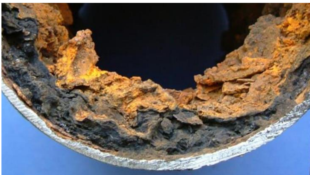
Slika 6. Korozijski produkti unutar cjevovoda tehnološke vode [10]
