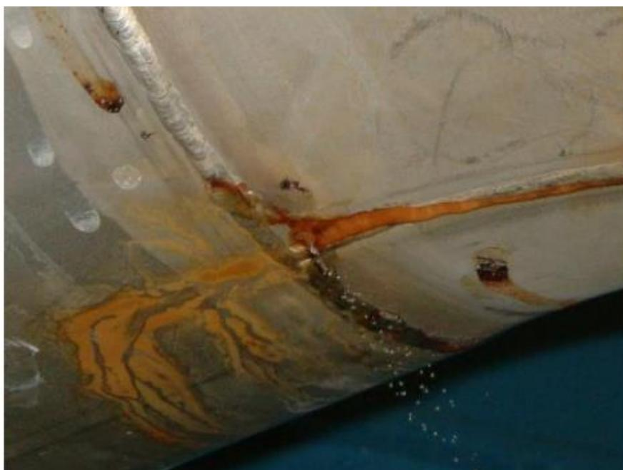
**Slika 7. Propuštanje vode u području zavarenog spoja na čeliku AISI 304L izazvano korozijskim procesima uslijed mikrobiološkog djelovanja [10]**
