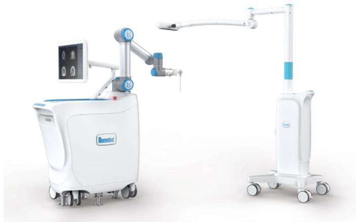
Slika 10. Remebot, robotski sustav korišten u području neurokirurgije [17]
