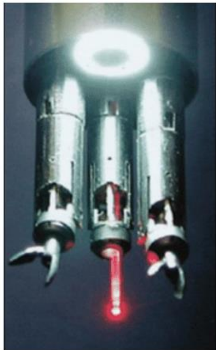
Slika 13. Uvećani prikaz vrha cilindričnog alata za odsijecanje [20]
