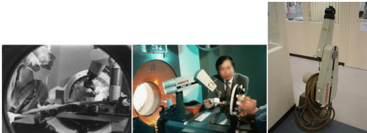
Slika 4. Puma 200, prvi robotski sustav korišten kao asistent u neurokirurgiji: a) operativni postupak (lijevo), b) simulacija postupka (sredina), c) robot (desno) [5, 6]
