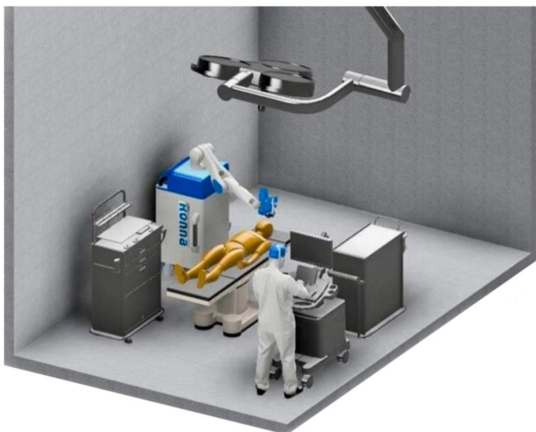
Slika 73. Renderirani prikaz operativne sale s pojednostavljenim modelom robotskog sustava RONNA i pozicioniranim prototipom
