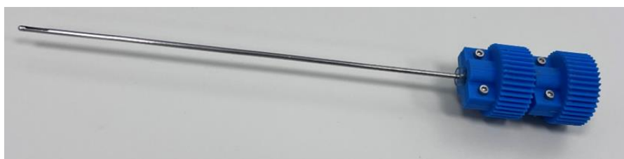
Slika 90. Montaža gonjenih zupčanika 1 i 2 na biopsijsku sondu
