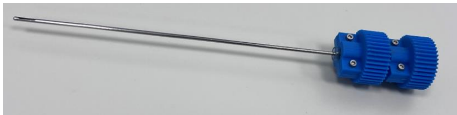
Slika 90. Montaža gonjenih zupčanika 1 i 2 na biopsijsku sondu
