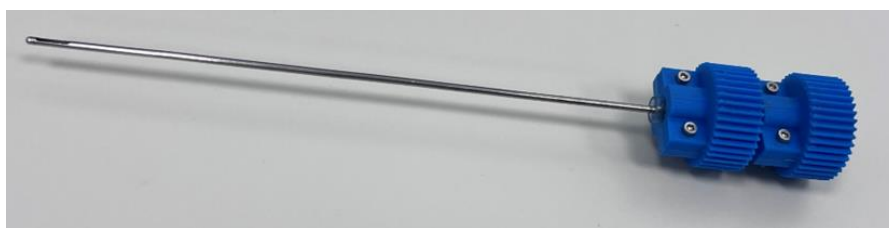
Slika 90. Montaža gonjenih zupčanika 1 i 2 na biopsijsku sondu
