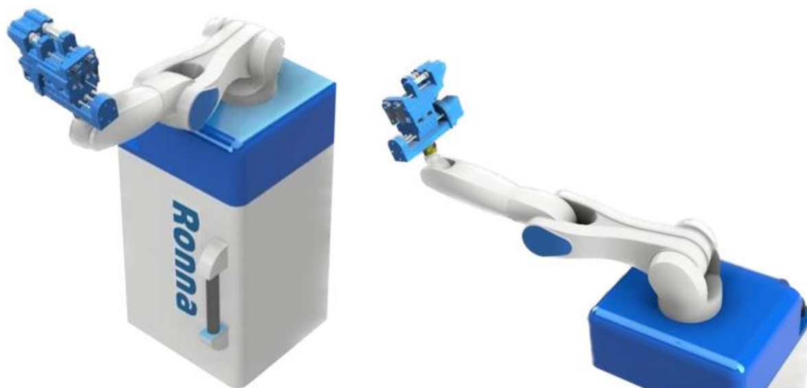
Slika 72. Renderirani prikaz robotskog sustava RONNA s postavljenim funkcionalnim prototipom na završetku robotske ruke
