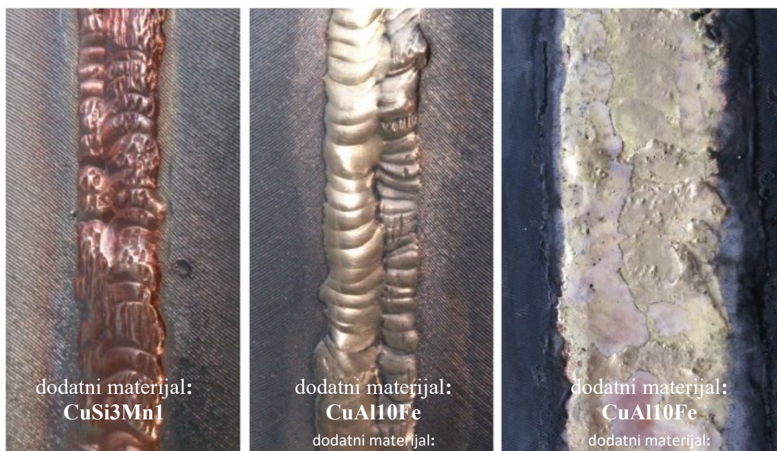
Slika 20 Prikaz prednje strane lemljenog spoja [13]
