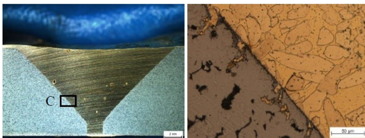
Slika 25 Makrostruktura (lijevo) i mikrostruktura na lokaciji C za lemljeni spoj gdje je dodatni materijal CuZn40SnSi (desno) [13]
