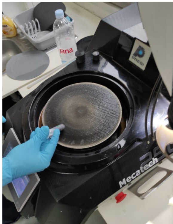
Slika 31 Stavljanje dijamentne paste na tkaninu za poliranje
