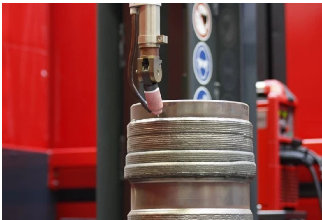
Slika 1 Navarivanje u svrhu poboljšavanja svojstva [2]
