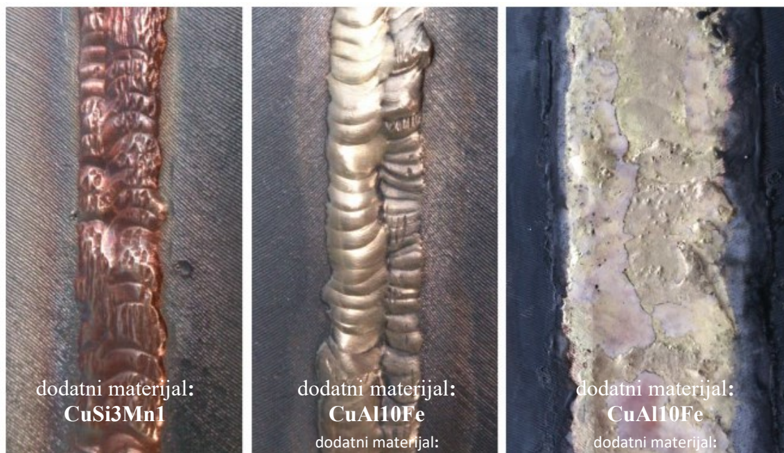
Slika 20 Prikaz prednje strane lemljenog spoja [13]
