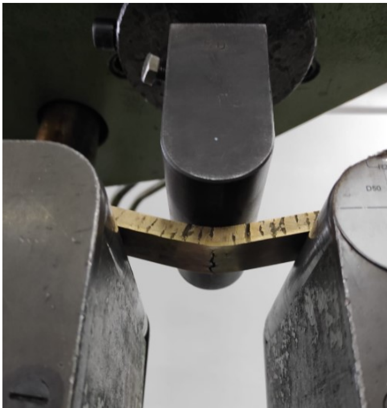
Slika 50 Pojava pukotine tijekom savijanja
