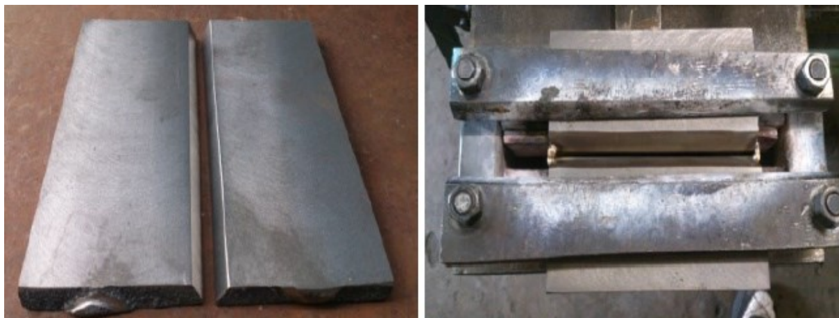
Slika 19 Uzorci spremni za lemljenje [13]
