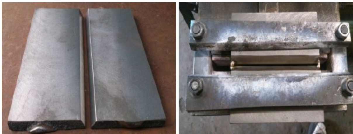
Slika 19 Uzorci spremni za lemljenje [13]
