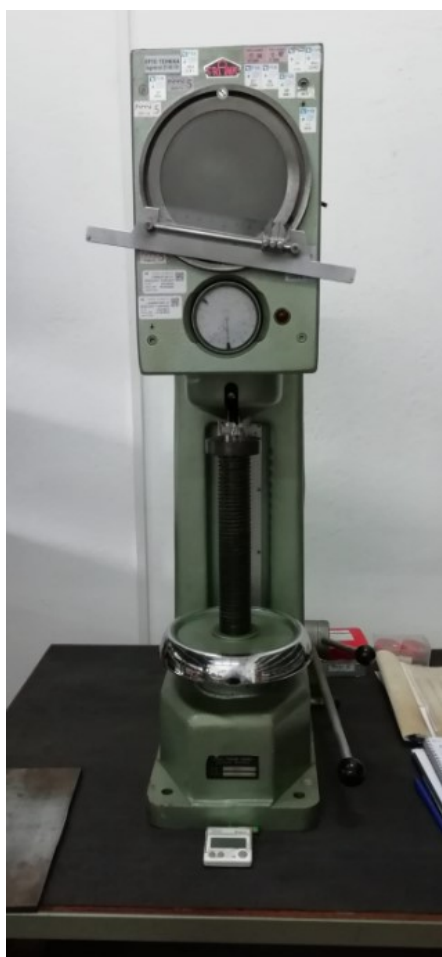
Slika 54 Uredaj za ispitivanje tvrdoće HV10
