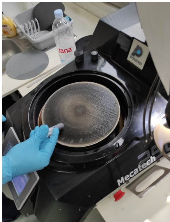
Slika 31 Stavljanje dijamentne paste na tkaninu za poliranje
