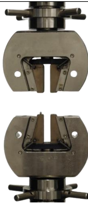
Slika 5.1. Mehaničke klinaste čeljusti proizvođača ZwickRoell
