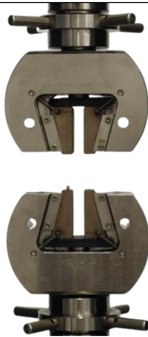
Slika 5.1. Mehaničke klinaste čeljusti proizvođača ZwickRoell
