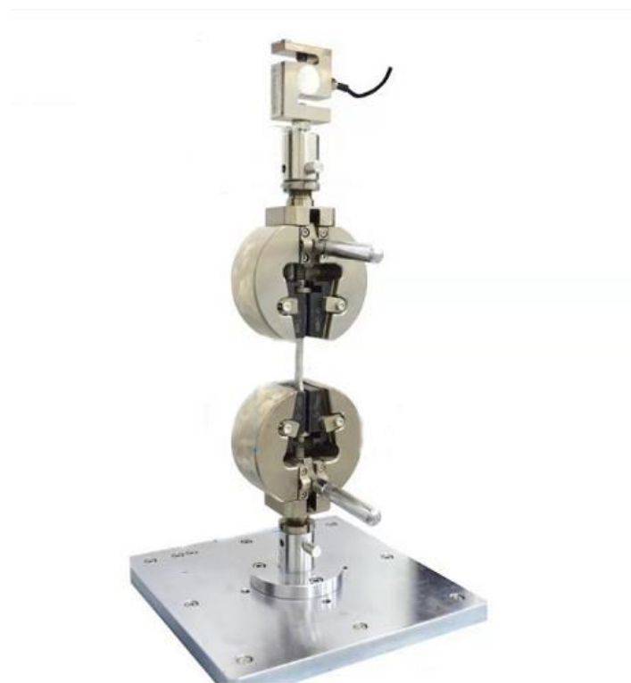
Slika 7.13. Set pretvornika sile, čeljusti i adaptera
