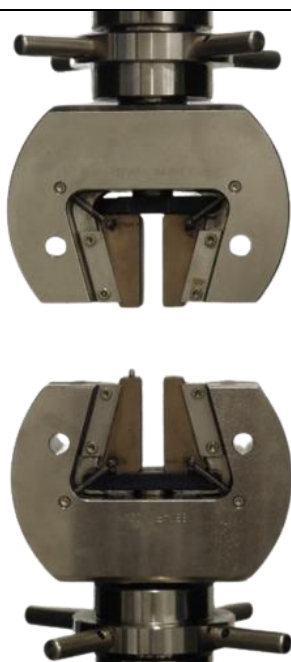
Slika 5.1. Mehaničke klinaste čeljusti proizvođača ZwickRoell
