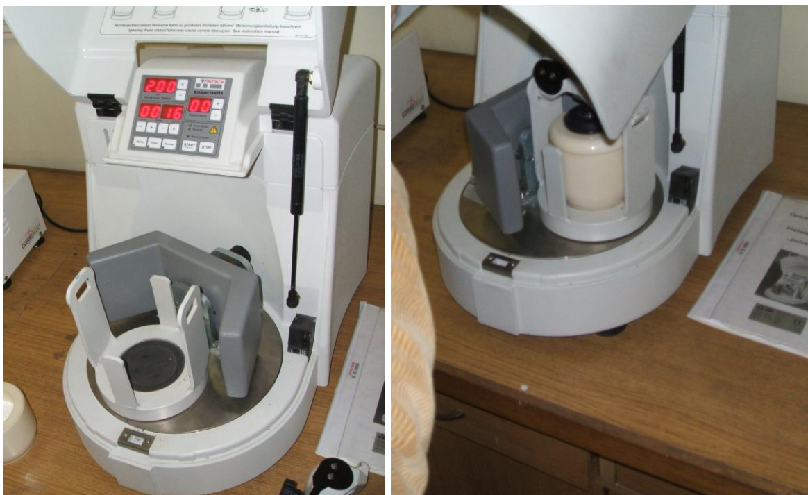
Slika 3.2.a i 3.2.b Planetarni kuglični mlin (Pulverisette 6, Fritsch, Germany).
