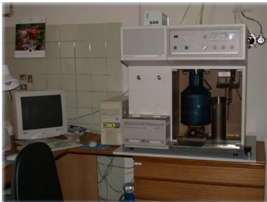
Slika 3.11. Porozimetar Carlo Erba 2000WS
