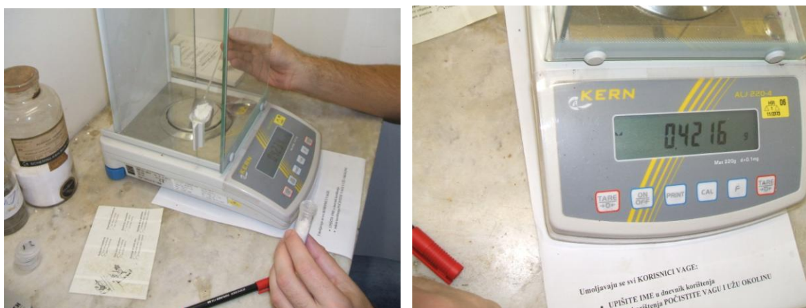
Slika 3.1.a i 3.1.b Određivanje masenog udjela pojedinih elemenata u suspenziji.
