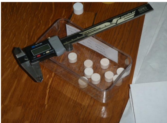
Slika 3.8.. Pomična mjerka korištena za određivanje dimenzija uzoraka.
