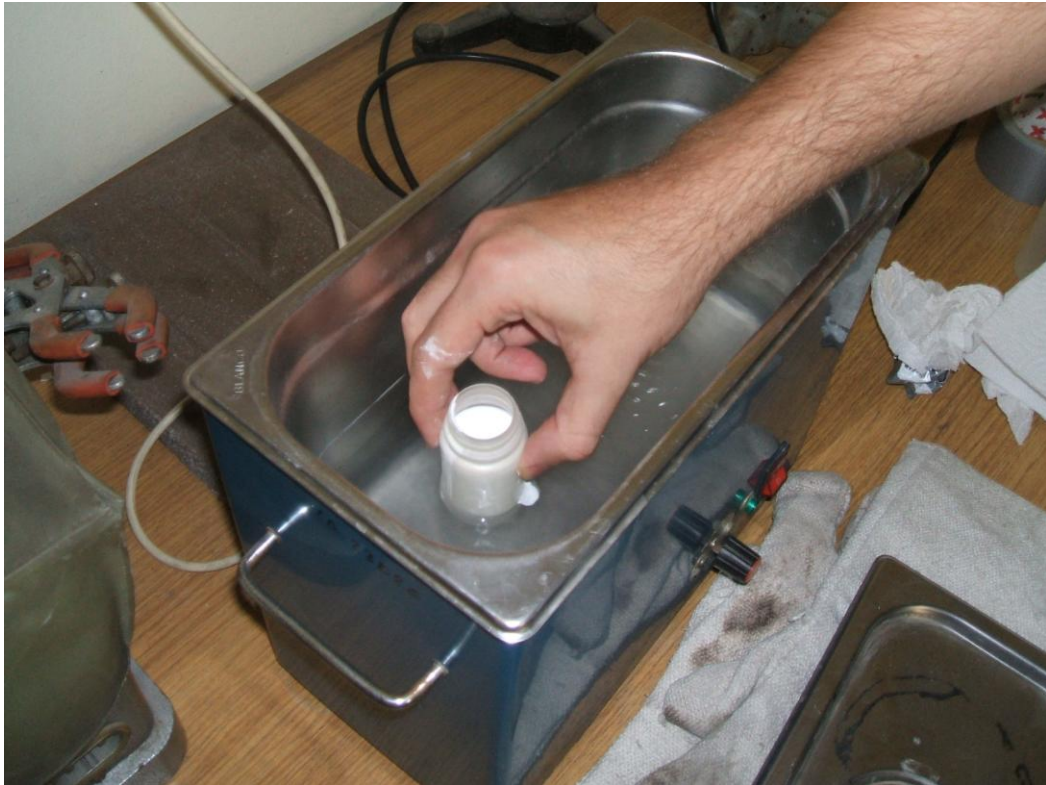
Slika 3.4. Uklanjanje mjehurića zraka u ultrazvučnoj kupelji.
