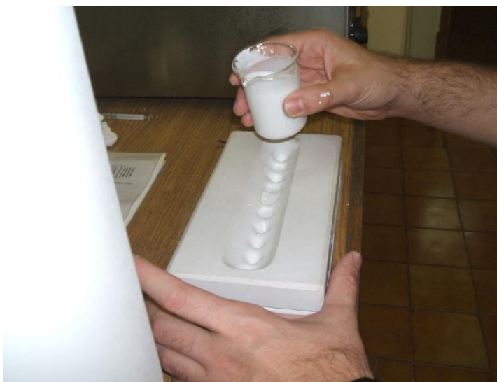
Slika 3.6. Lijevanje u gipsani kalup
