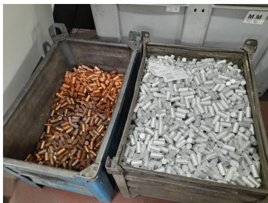
Slika 47. Cu i Al sirovci namijenjeni za zavarivanje trenjem
