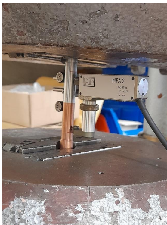
Slika 61. Montirana ispitna epruveta spremna na vlačni test
