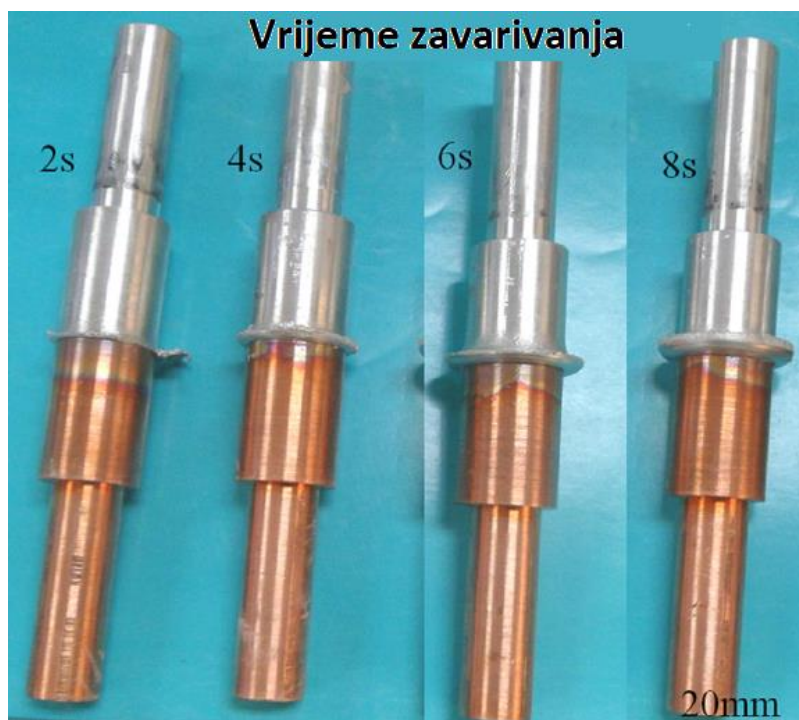
Slika 36. Uzorci Al i Cu pod različitim vremenom zavarivanja [13]
