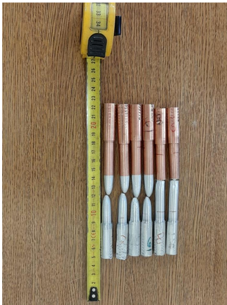
Slika 64. Uzorci 2, 3, 4, 6, 8 i 9 nakon vlačnog testa
