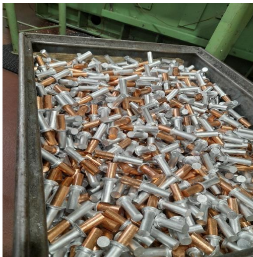
Slika 48. Zavareni Al-Cu sirovci sa srhom izbačenog materijala
