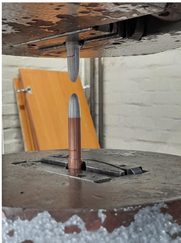
Slika 62. Uzorak 2 - odvajanje spoja na Al dijelu epruvete ( p_s = 25 bar)
