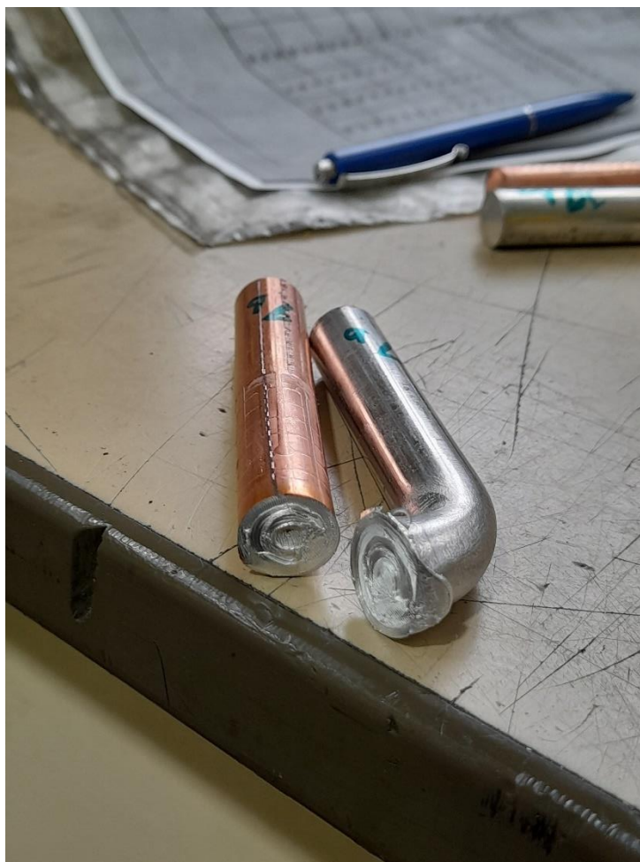
Slika 56. Neispravno puknuće spoja
