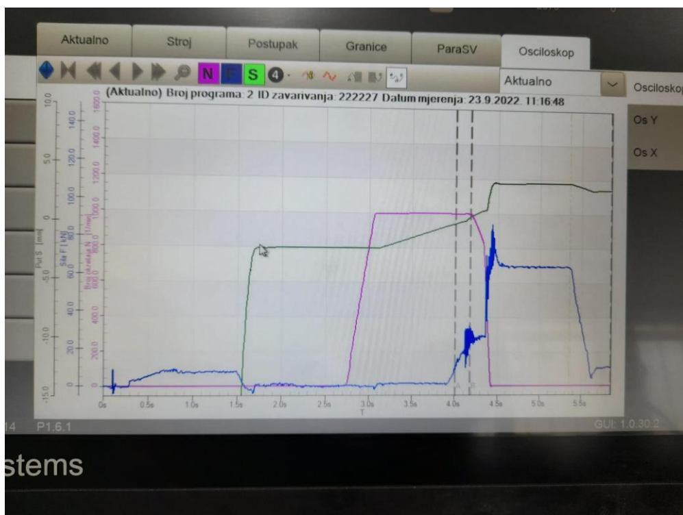
Slika 53. Grafički prikaz kretanja sile, brzine vrtnje i aksijalnog pomaka u odnosu na vrijeme tokom postupka zavarivanja trenjem
