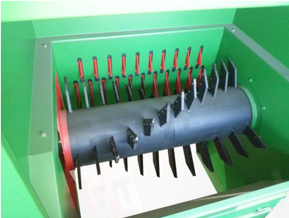
Slika 19. Noževi otvarača vrećica [37]
