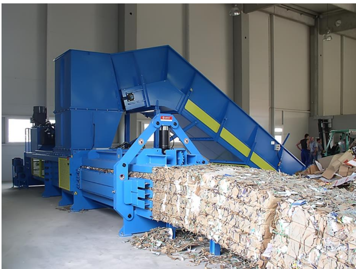
Slika 36. Preša za baliranje papira [57]
