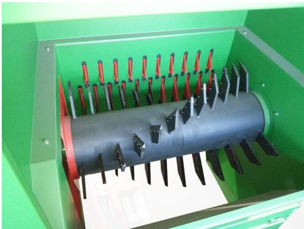
**Slika 19.** Noževi otvarača vrećica [37]
