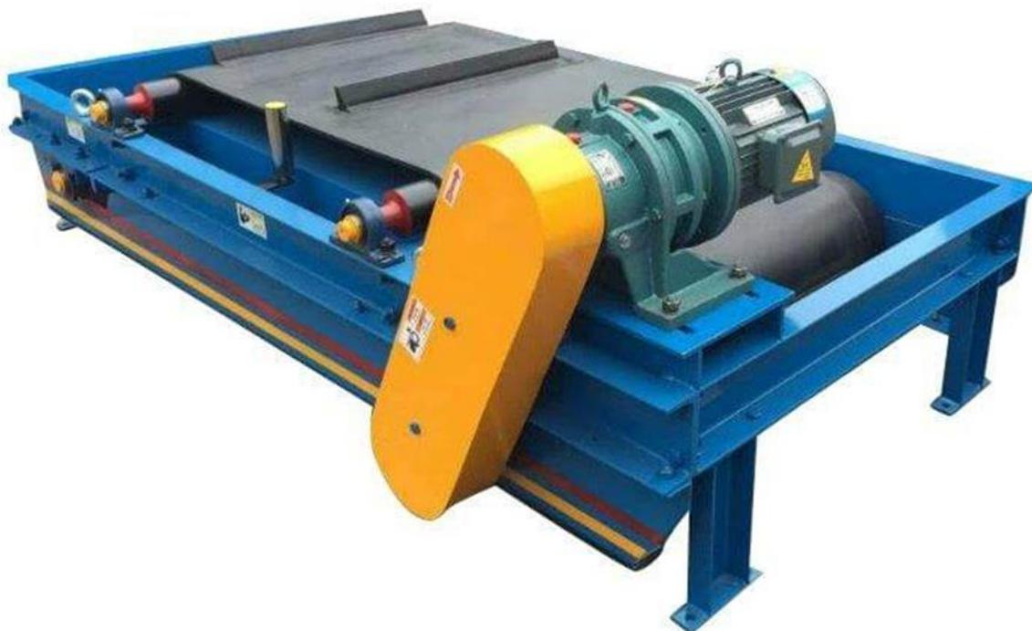
Slika 31. Magnetski separator [50]
