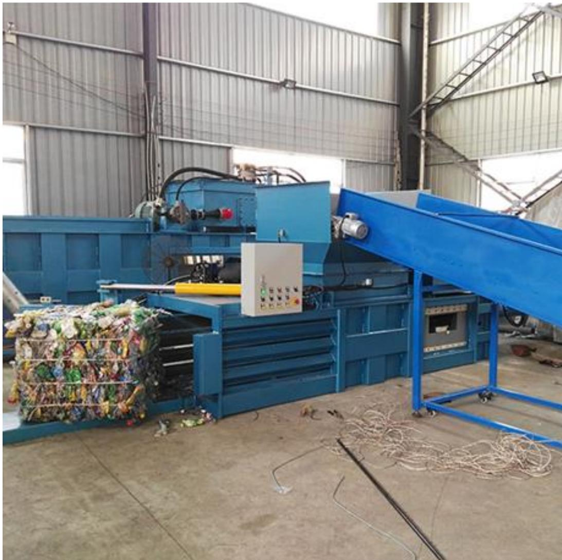
Slika 37. Preša za baliranje polimernih materijala [58]
