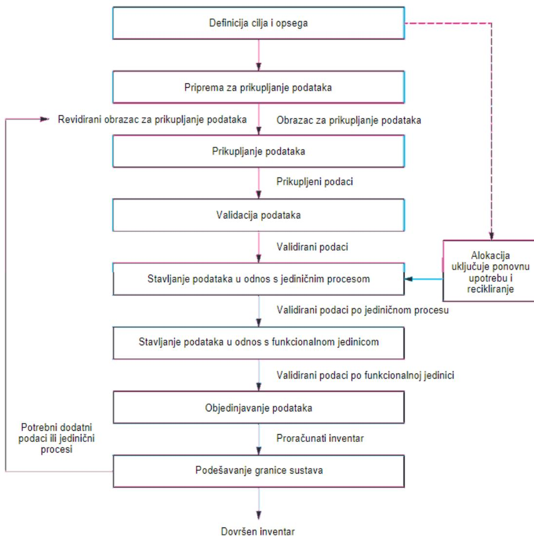
**Slika 2. Pojednostavljeni grafički prikaz izrade inventara [20]**
