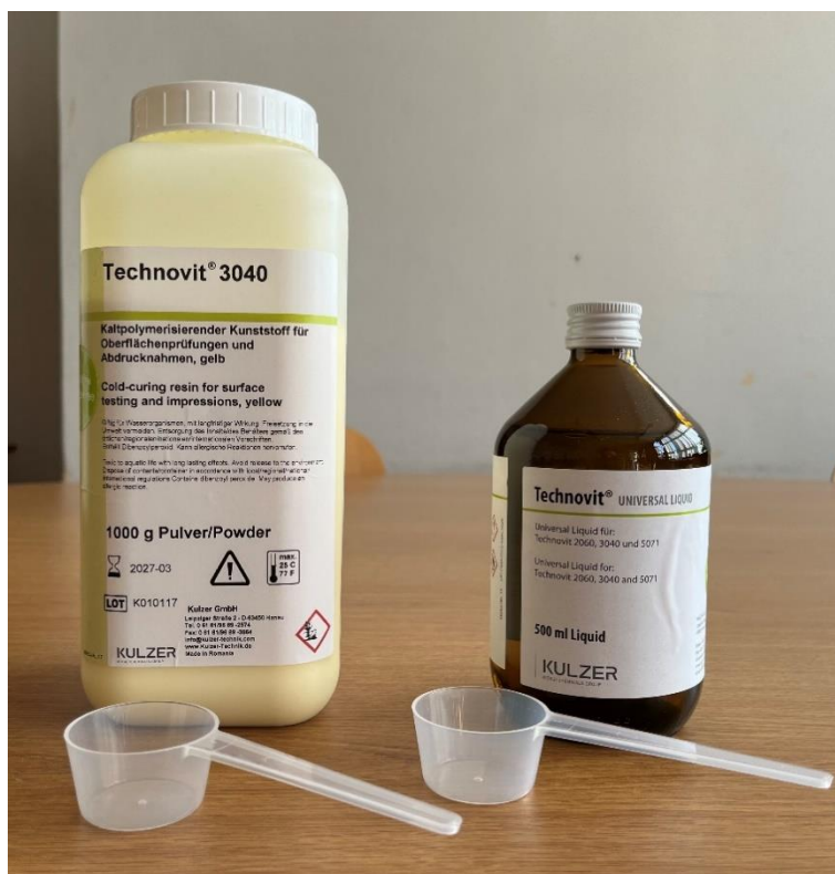
Slika 38. Technovit 3040 prah i Technovit univerzalna tekućina
