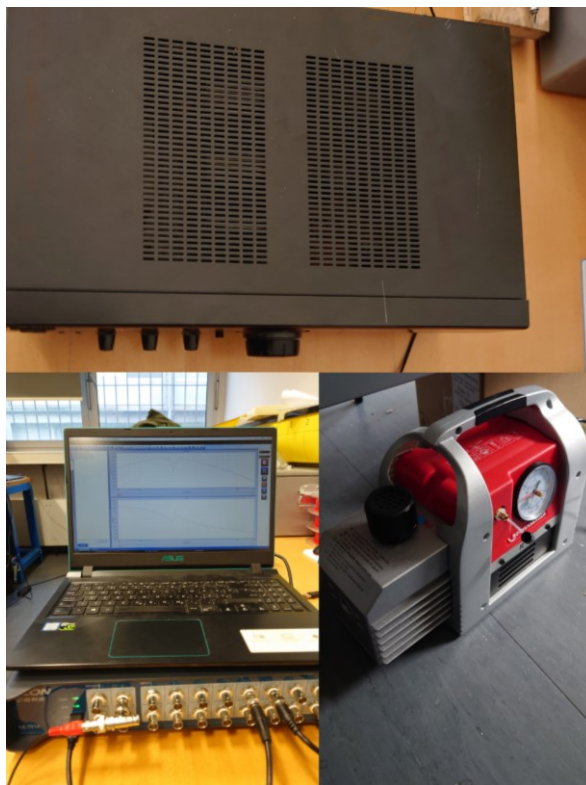
Slika 5.1 Eksperimentalni postav – prijenosno računalo, analizator spektra, pojačalo (gore) i vakuum pumpa (dolje desno)
