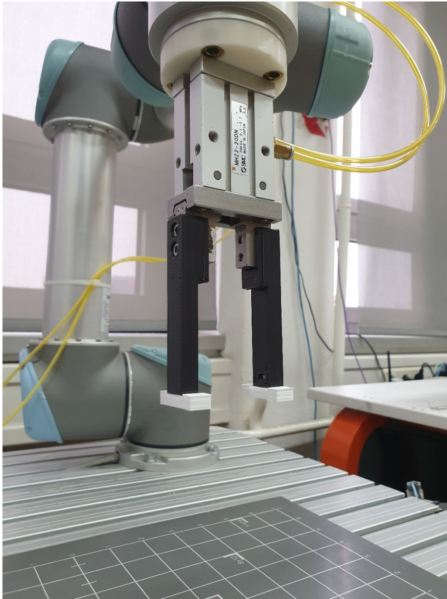
Slika 6.7. Hvataljka spojena na robotsku prirubnicu
