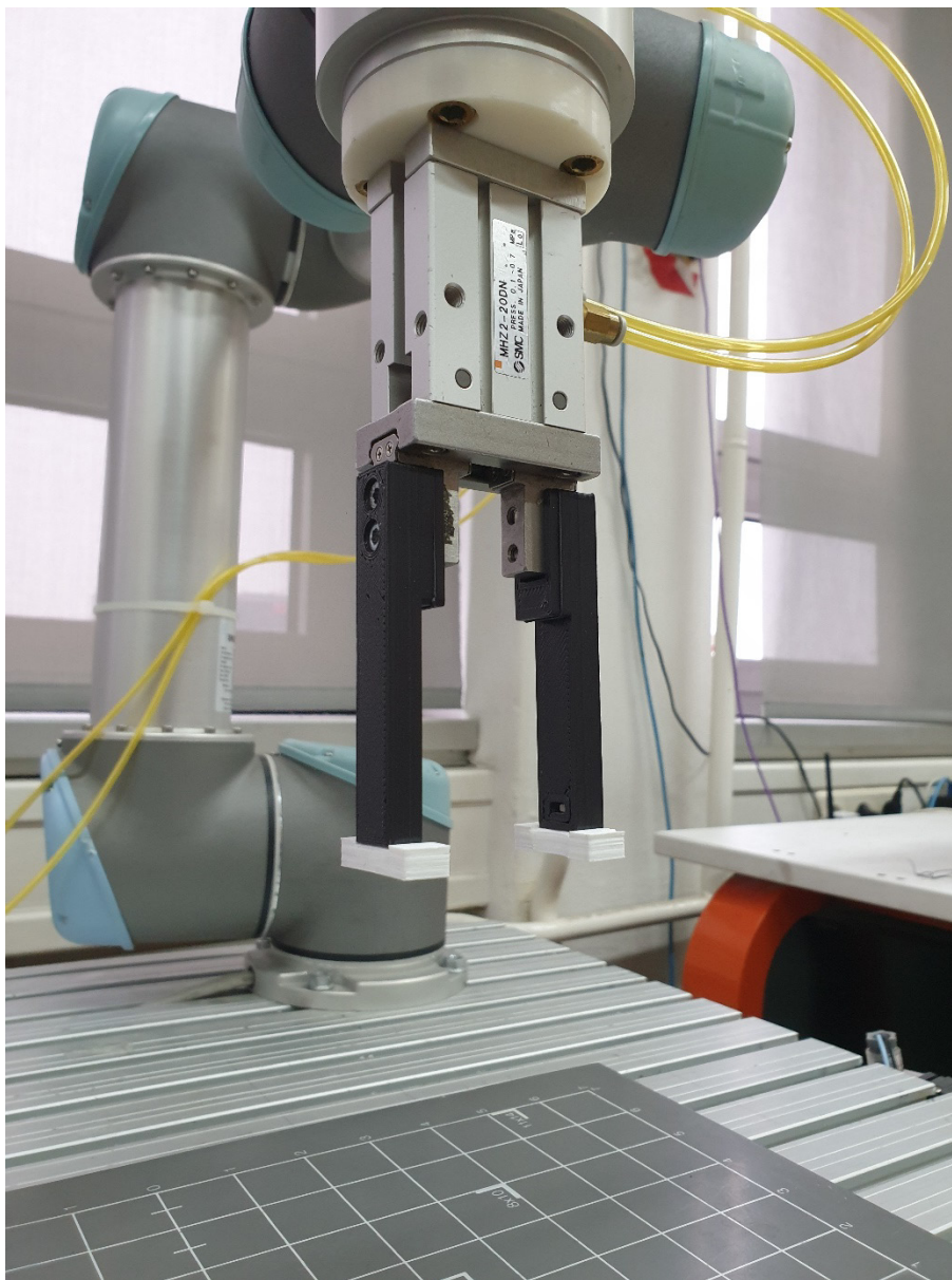
Slika 6.7. Hvataljka spojena na robotsku prirubnicu
