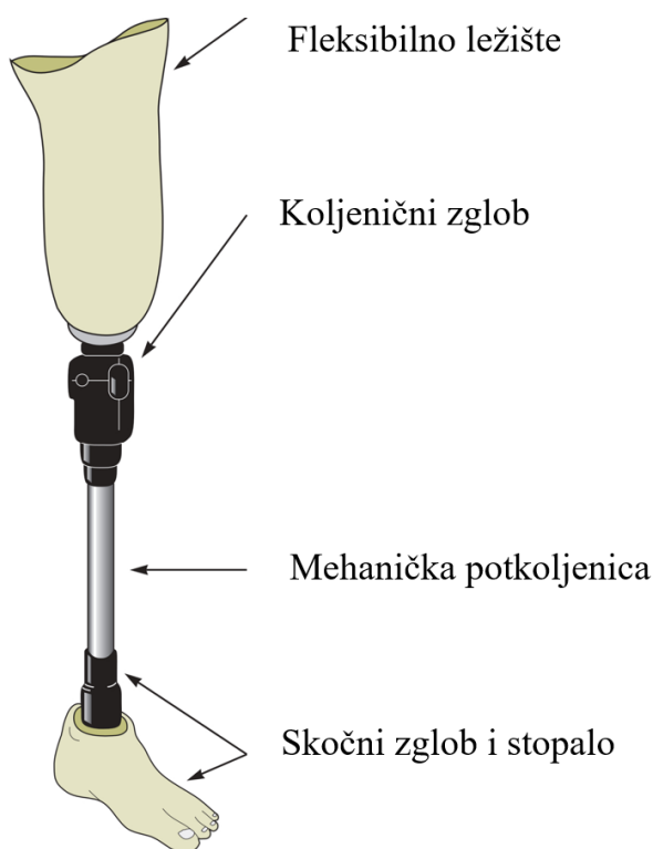
Slika 2. Osnovni dijelovi endoskeletne proteze potkoljenice [3]
