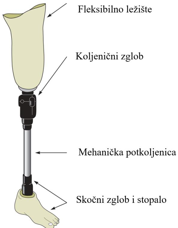
**Slika 2. Osnovni dijelovi endoskeletne proteze potkoljenice [3]**
