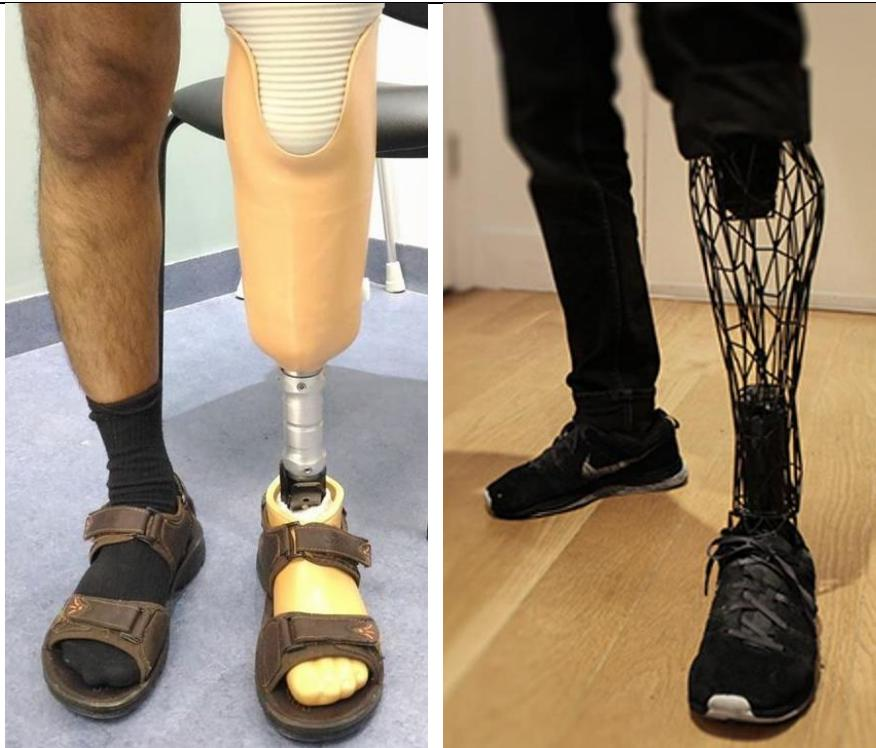
**Slika 20.** Usporedba proizvoda nastalog konvecionalnim i aditivnim postupkom proizvodnje [38, 39]
