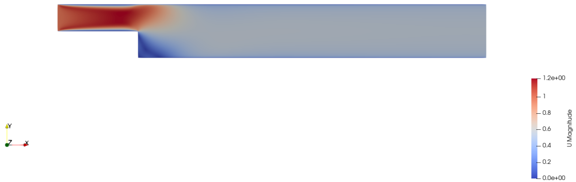
Slika 6.12: Polje brzine na mreži od 76800 kontrolnih volumena u 24000. iteraciji
