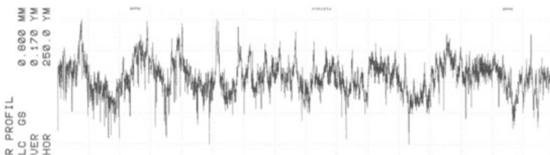
**Slika 29. Profil hrapavosti prevlake PAVCD TiN na aditivno proizvedenoj leguri Ti6Al4V**
