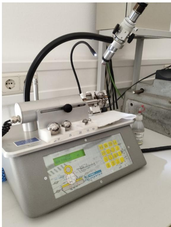
**Slika 33. Uređaj Tribotechnic calotester za ispitivanje debljine prevlake**
