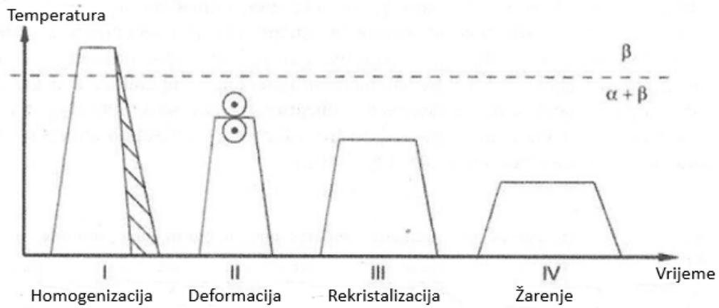
Slika 10. Drugi način toplinsko-mehaničke obrade na izotropnu strukturu [1]
