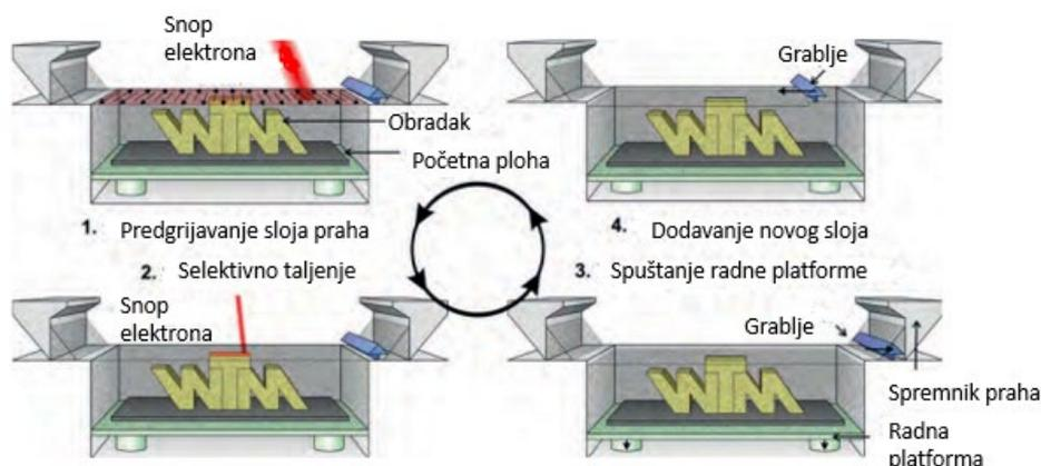
Slika 14. Shematski prikaz postupka EBM [7]
