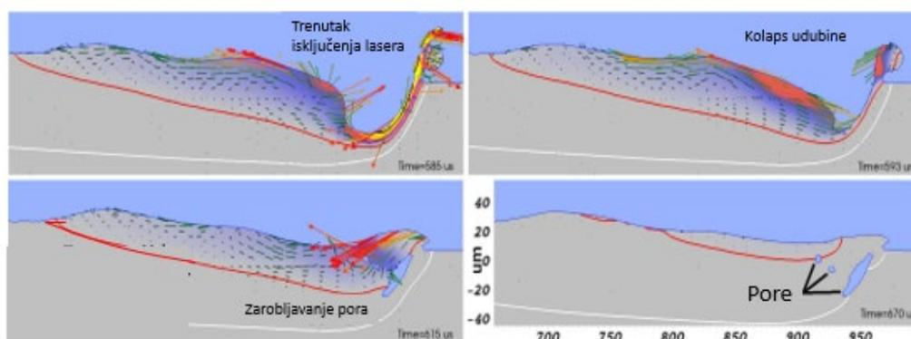
Slika 15. Mehanizam nastanka pora [9]
