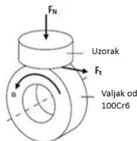
Slika 20. Shema metode za mjerenje trošenja [14]
