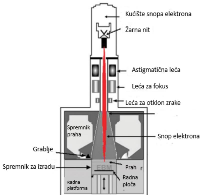
Slika 13. Shema uređaja za EBM postupak [4]
