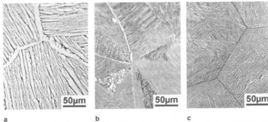
Slika 7. Mikrostruktura pri brzini hlađenja od a) 1 K/min b) 100 K/min i c) 1000 K/min [1]
