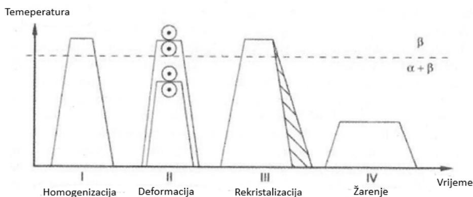
**Slika 6. Toplinsko-mehanička obrada na potpuno lamelarnu strukturu [1]**
