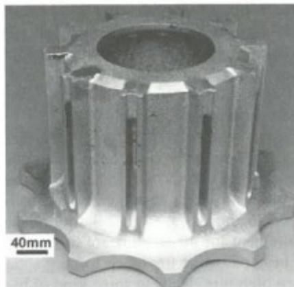
Slika 4. Momentna cijev kočnice aviona [1]
