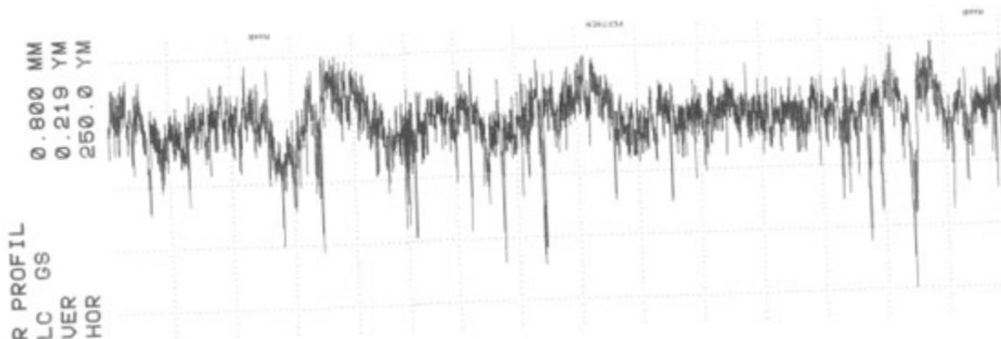
**Slika 28. Profil hrapavosti prevlake PAVCD TiN na konvencionalno proizvedenoj leguri Ti6Al4V**
