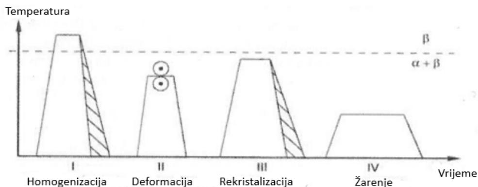
Slika 8. Toplinsko-mehanička obrada na duplex strukturu [1]
