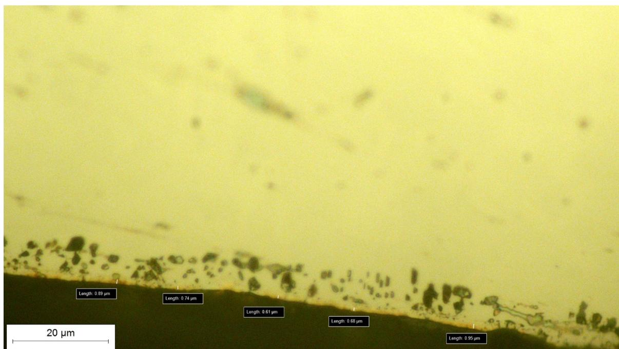
Slika 36. Poprečni presjek aditivno proizvedene legure Ti6Al4V
