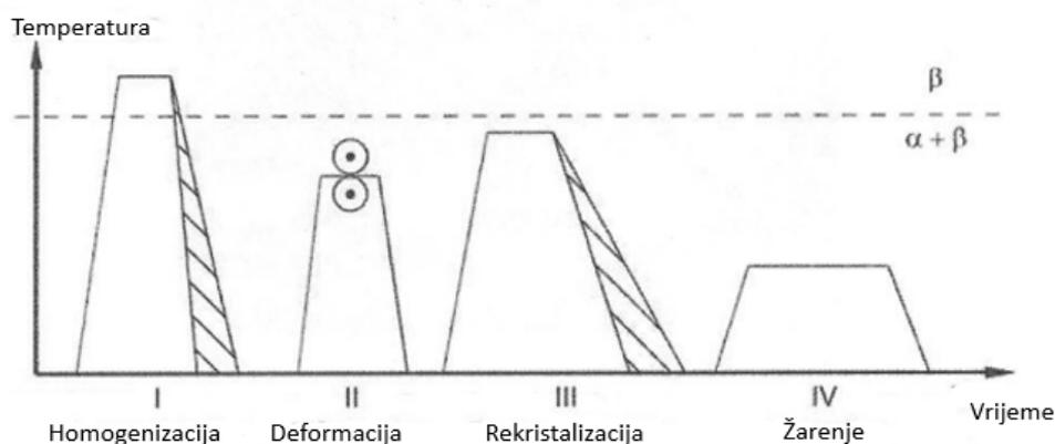
Slika 9. Prvi način toplinsko-mehaničke obrade na izotropnu strukturu [1]
