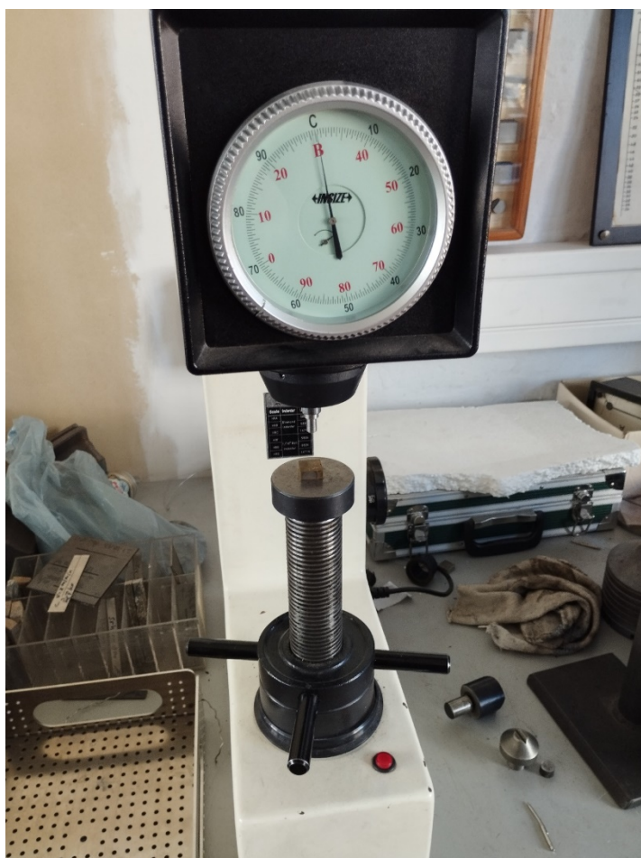
Slika 31. Određivanje adhezivnosti prevlake na Rockwell C tvrdomjeru
