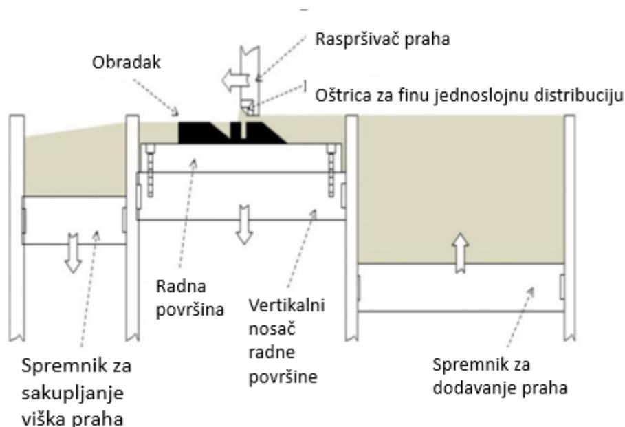
Slika 11. Shematski prikaz postupka SLM [4]
