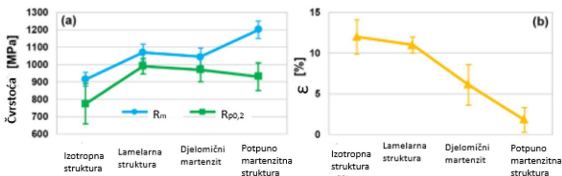
Slika 16. Mehanička svojstva u ovisnosti o strukturi [10]
