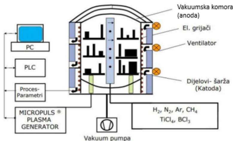
Slika 19. Shematski prikaz postupka PACVD [11]
