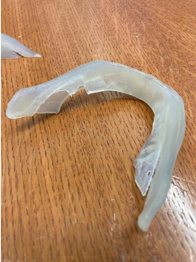
**Slika 34 Prototip kirurške vodilice nakon uklanjanja potporne strukture**
