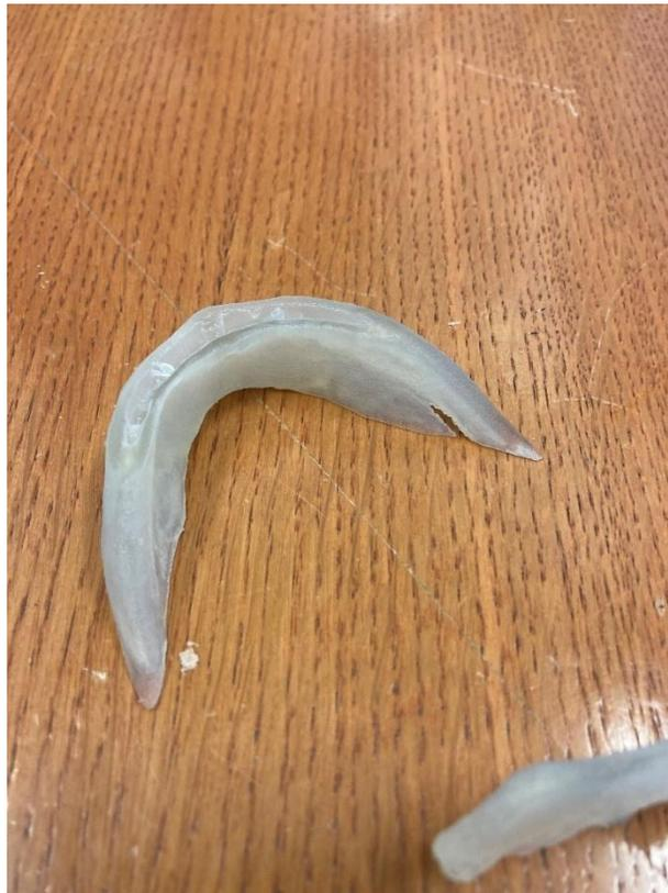
**Slika 33 Prototip implantata nakon uklanjanja potporne strukture**
