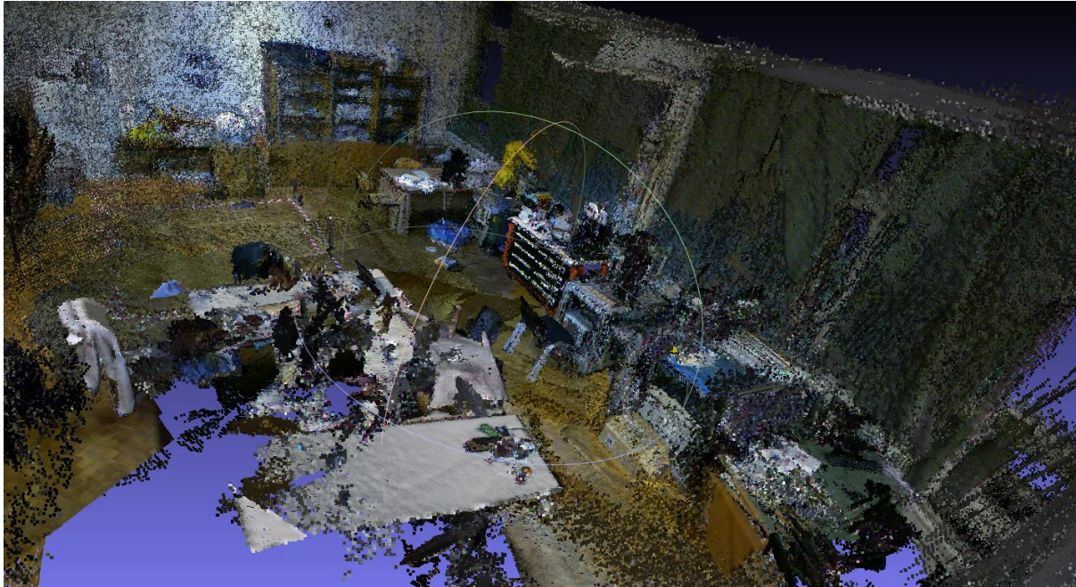
Slika 30. Pogled 2- Oblak točkaca proizašao iz snimki sa kamerom Xbox360 Kinect
