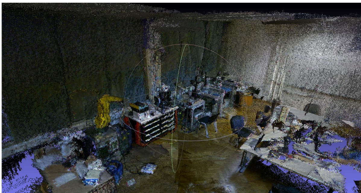
Slika 29. Pogled 1- Oblak točaka proizašao iz snimki sa kamerom Xbox360 Kinect
