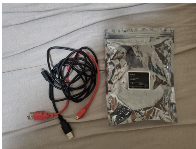
Slika 34. Kabel za vanjsku bateriju (crveno) i kabel za direktno spajanje (crno)
